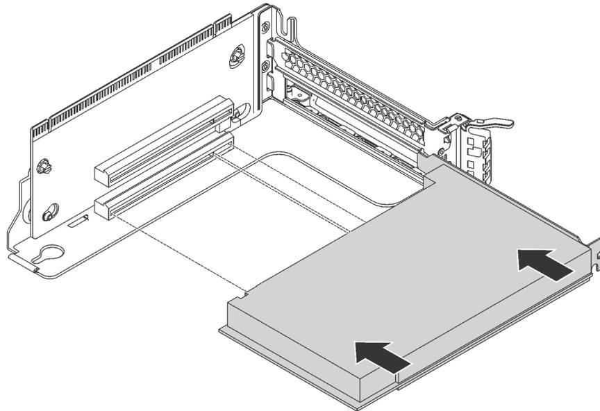
Рис. 100. Установка адаптера PCIe
