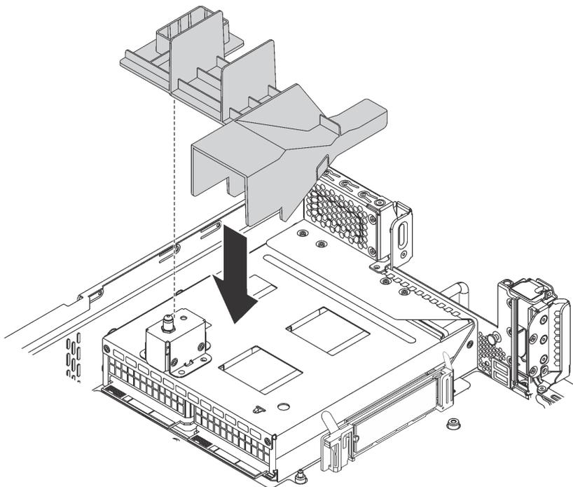
Рис. 93. Установка дефлектора диска M.2
