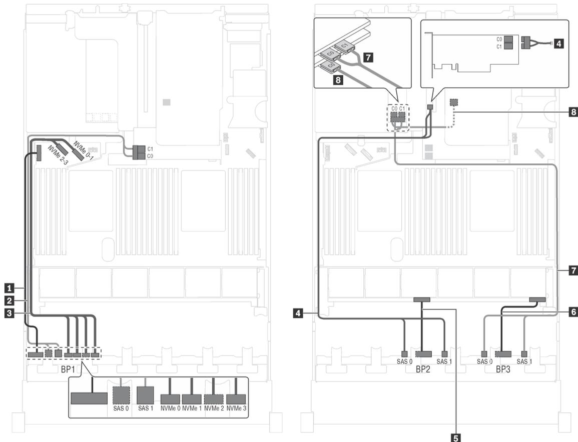
Рис. 52. Прокладка кабелей для моделей серверов с двадцатью 2,5-дюймовыми дисками SAS/SATA, четырьмя 2,5-дюймовыми дисками SAS/SATA/NVMe, задним блоком оперативно заменяемых дисков и четырьмя адаптерами RAID 8i
