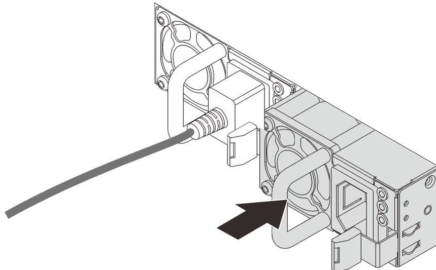
Рис. 111. Установка оперативно заменяемого блока питания
