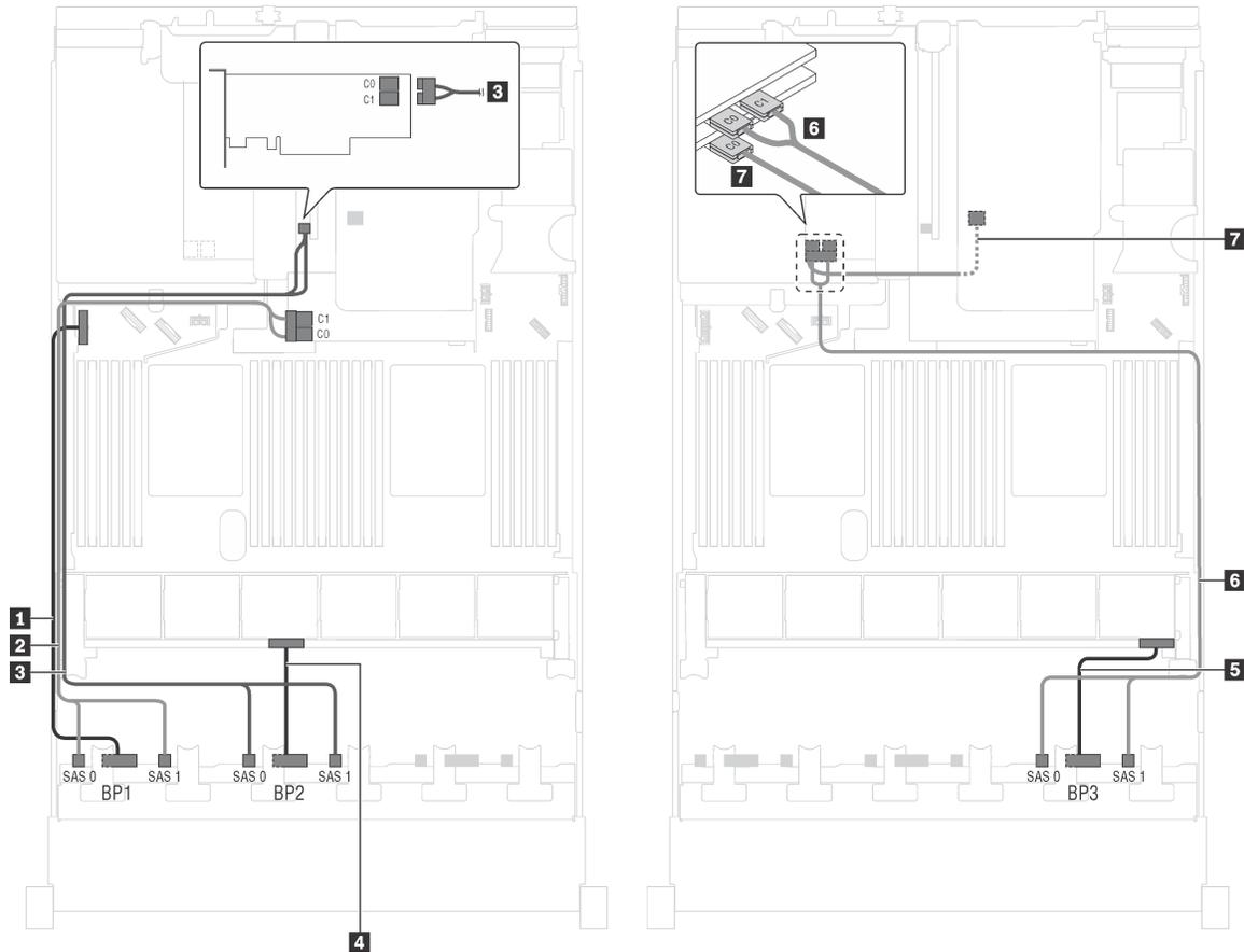
Рис. 46. Прокладка кабелей для моделей серверов с двадцатью четырьмя 2,5-дюймовыми дисками SAS/SATA, задним блоком оперативно заменяемых дисков и четырьмя адаптерами RAID 8i
