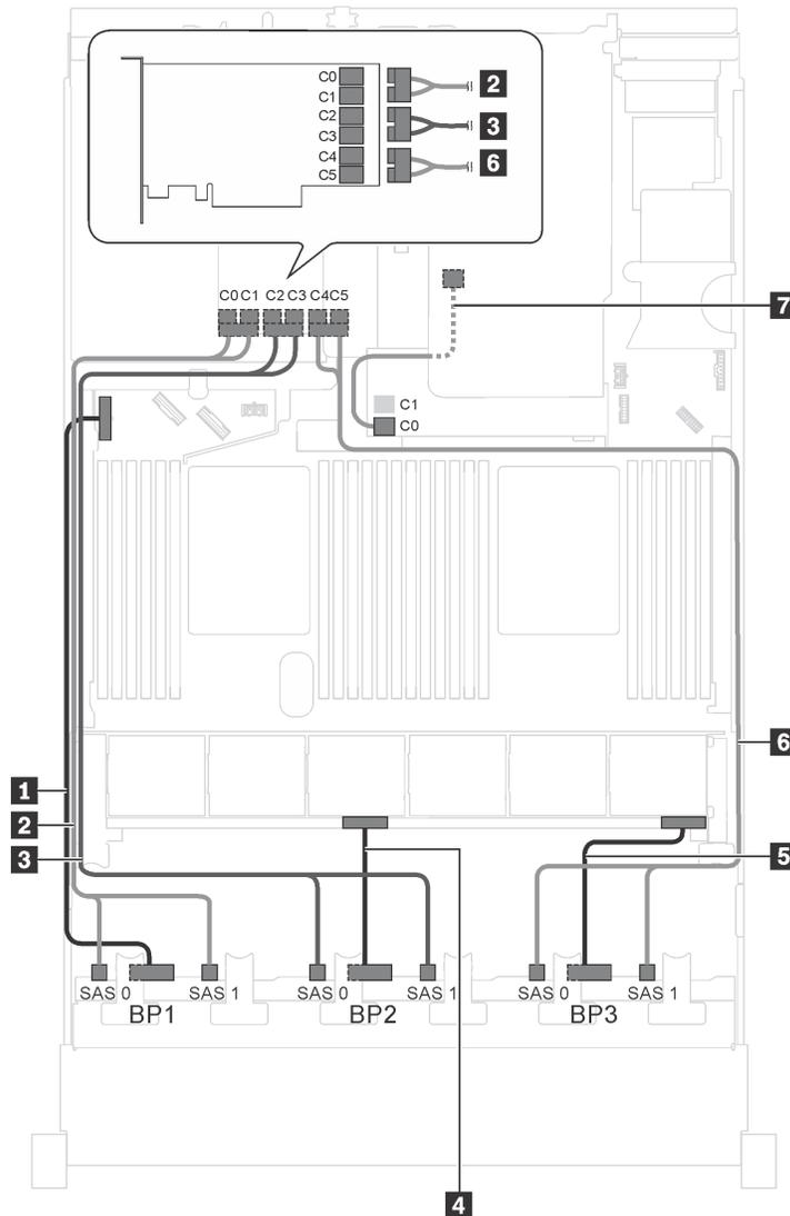
Рис. 48. Прокладка кабелей для моделей серверов с двадцатью четырьмя 2,5-дюймовыми дисками SAS/SATA, задним блоком оперативно заменяемых дисков, одним адаптером RAID 8i и одним адаптером RAID 24i
