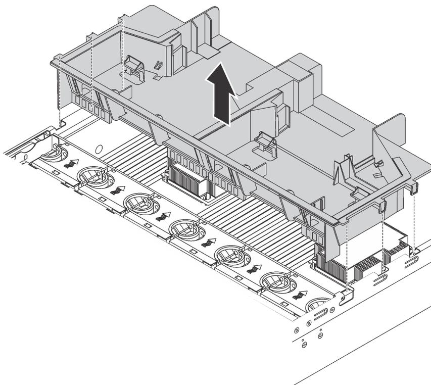
Рис. 77. Снятие дефлектора большого размера
