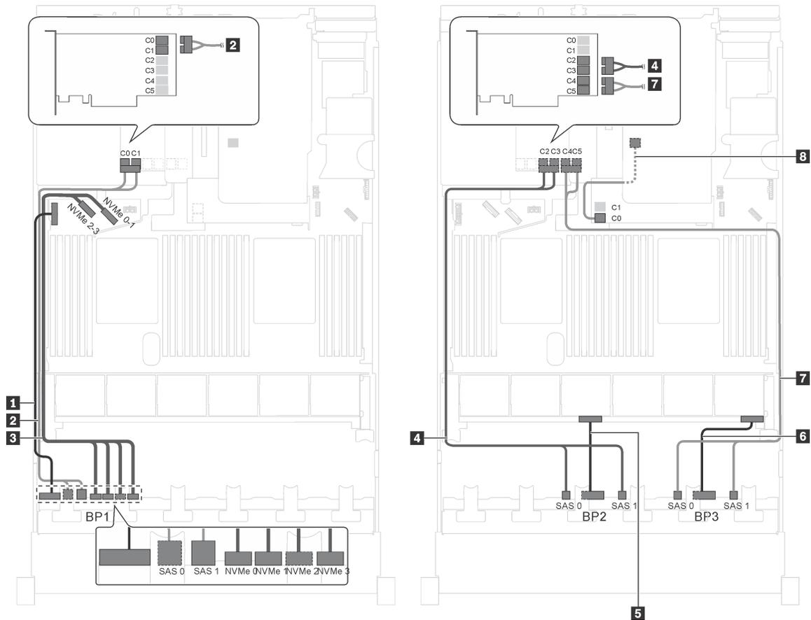
Рис. 54. Прокладка кабелей для моделей серверов с двадцатью 2,5-дюймовыми дисками SAS/SATA, четырьмя 2,5-дюймовыми дисками SAS/SATA/NVMe, задним блоком оперативно заменяемых дисков, одним адаптером RAID 8i и одним адаптером RAID 24i
