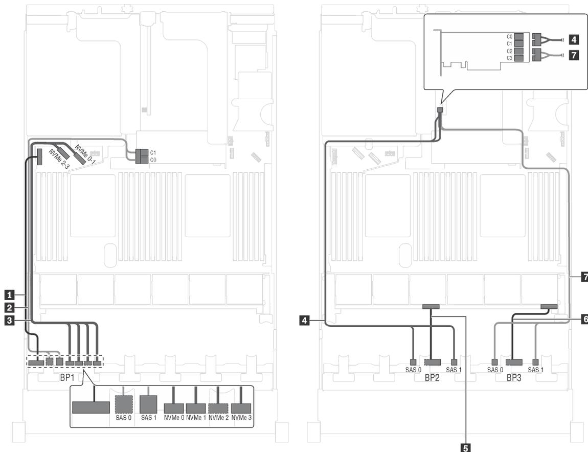
Рис. 50. Прокладка кабелей для моделей серверов с двадцатью 2,5-дюймовыми дисками SAS/SATA, четырьмя 2,5-дюймовыми дисками SAS/SATA/NVMe, одним адаптером RAID 8i и одним адаптером RAID 16i
