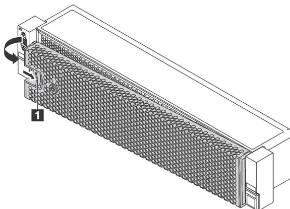
Рис. 74. Снятие защитной панели
