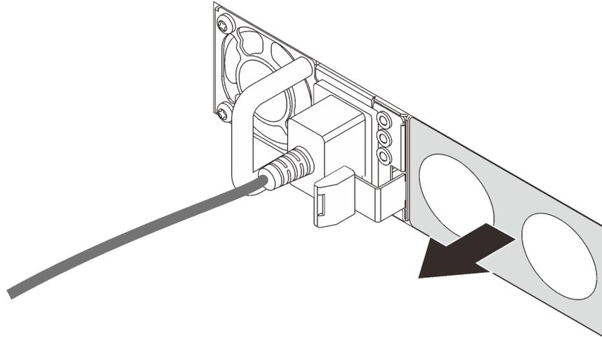
Рис. 110. Снятие заглушки оперативно заменяемого блока питания
