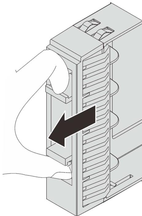
Рис. 116. Снятие заглушки 2,5-дюймового диска
