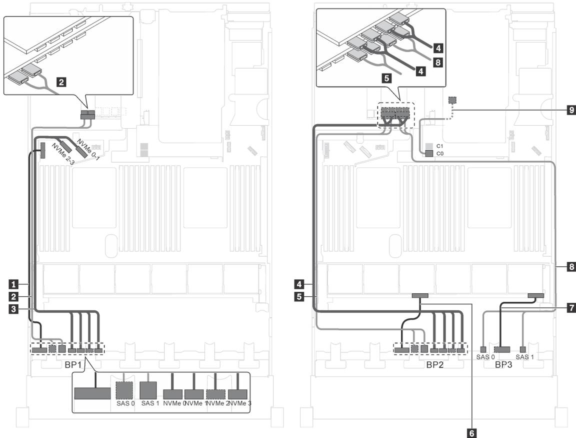
Рис. 57. Прокладка кабелей для моделей серверов с шестнадцатью 2,5-дюймовыми дисками SAS/SATA, восемью 2,5-дюймовыми дисками SAS/SATA/NVMe, задним блоком оперативно заменяемых дисков, одним адаптером RAID 8i, одним адаптером RAID 24i и одним адаптером-переключателем NVMe
