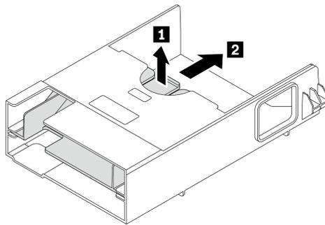
Рис. 98. Снятие центральной пластины
