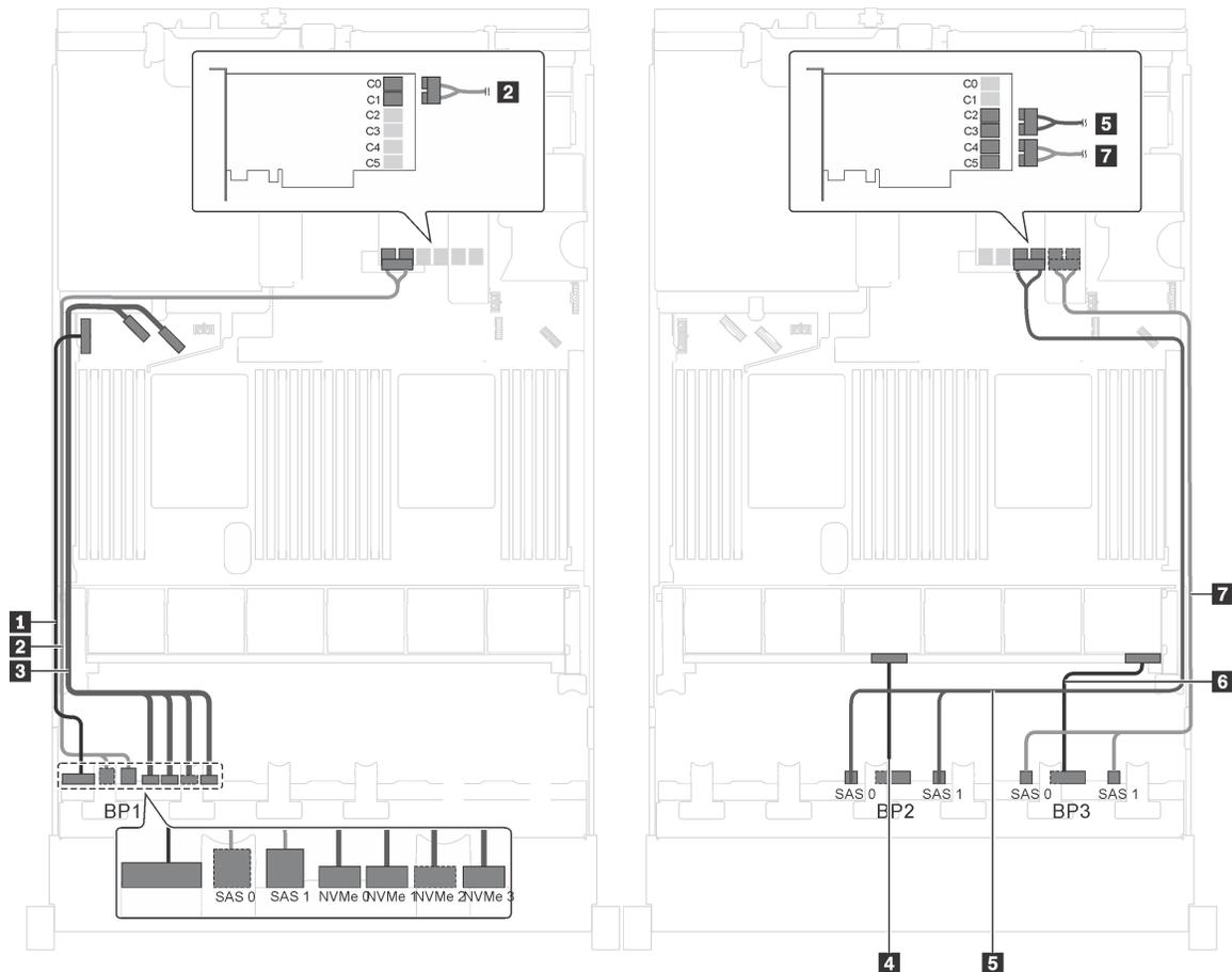
*Рис. 51. Прокладка кабелей для моделей серверов с двадцатью 2,5-дюймовыми дисками SAS/SATA, четырьмя 2,5-дюймовыми дисками SAS/SATA/NVMe и одним адаптером RAID 24i*
