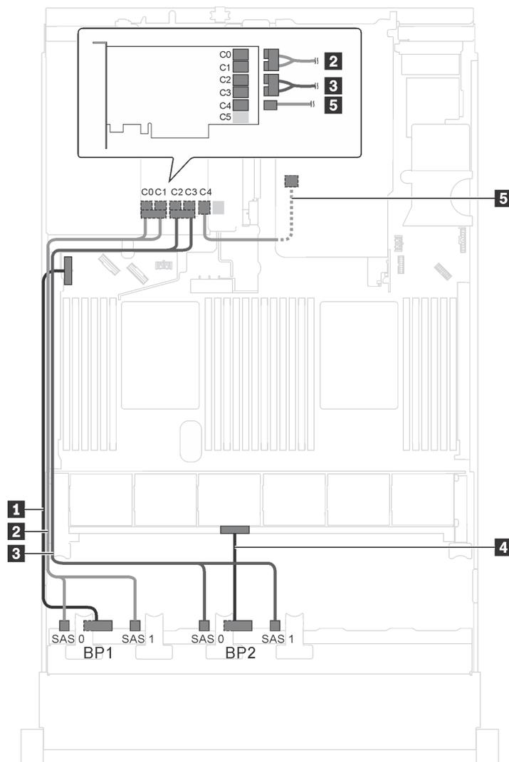
Рис. 32. Прокладка кабелей для моделей серверов с шестнадцатью 2,5-дюймовыми дисками SAS/SATA, задним блоком оперативно заменяемых дисков и одним адаптером RAID 24i
