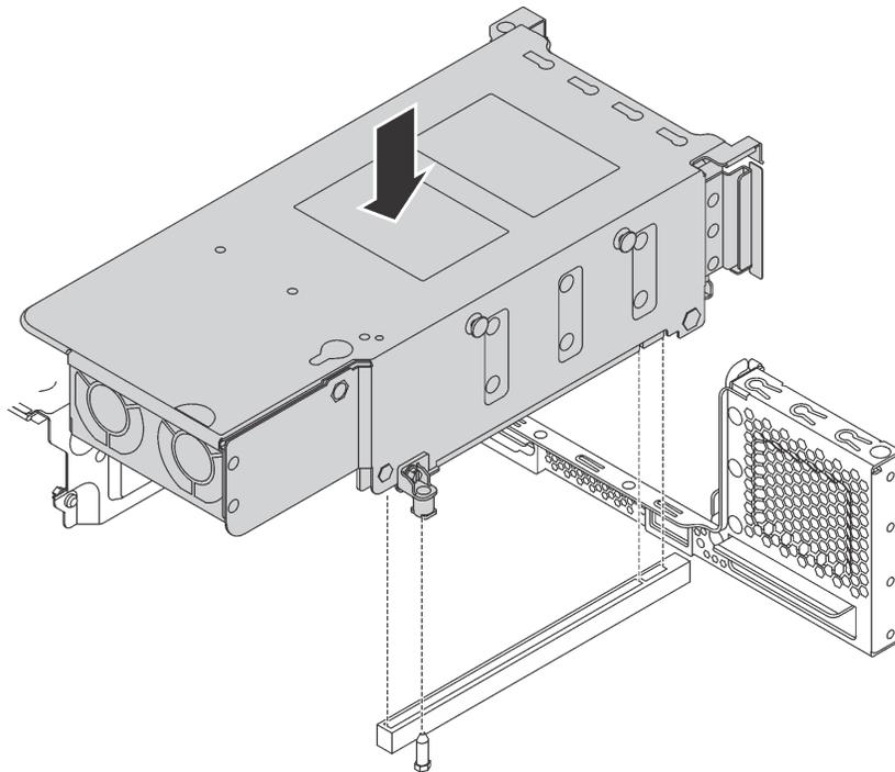
Рис. 87. Установка заднего блока оперативно заменяемых дисков
