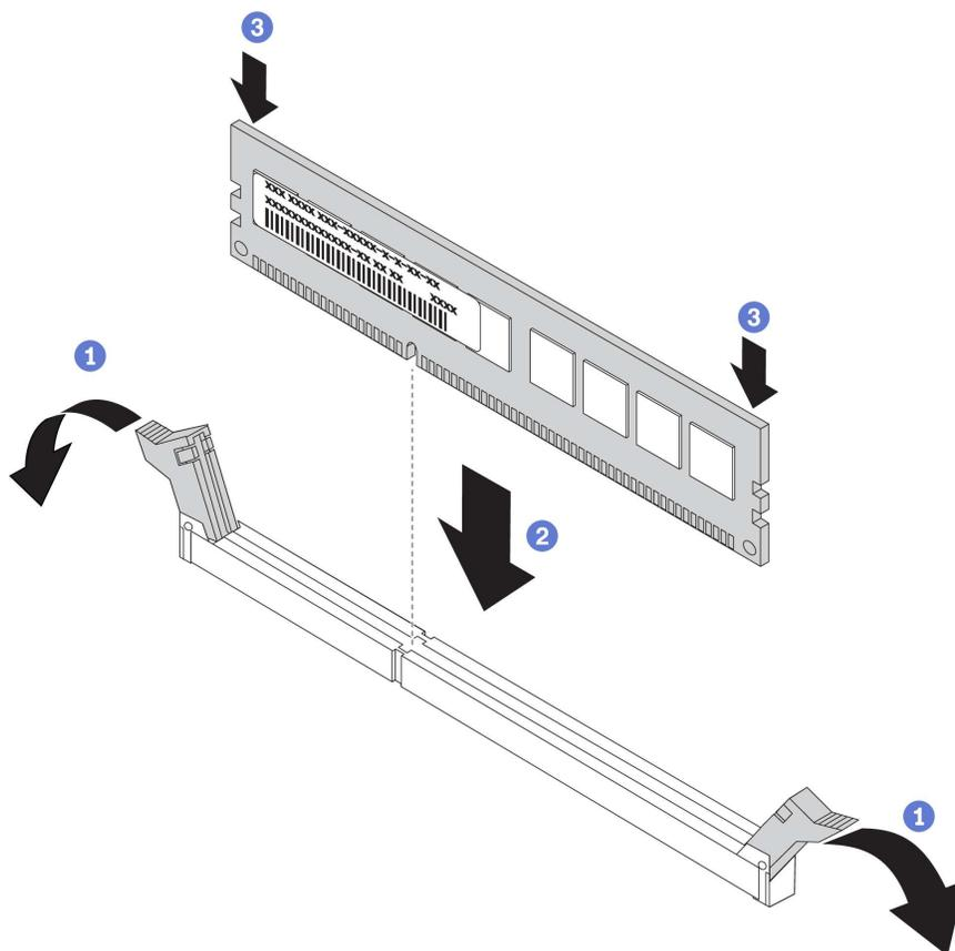
Рис. 80. установка модуля памяти
