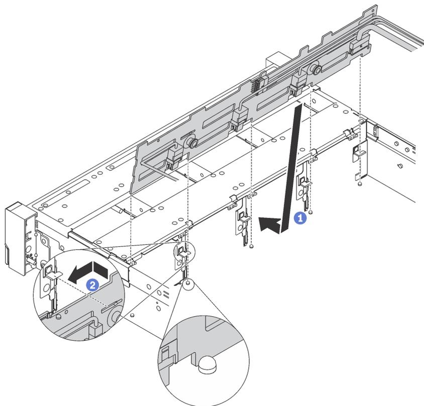
Рис. 85. Установка объединительной панели для 3,5-дюймовых дисков
