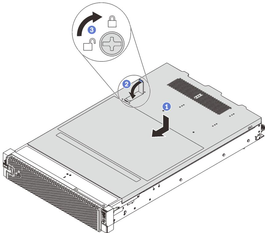
Рис. 115. Установка верхнего кожуха
