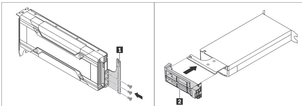
Рис. 96. Установка скобы и держателя графического процессора
