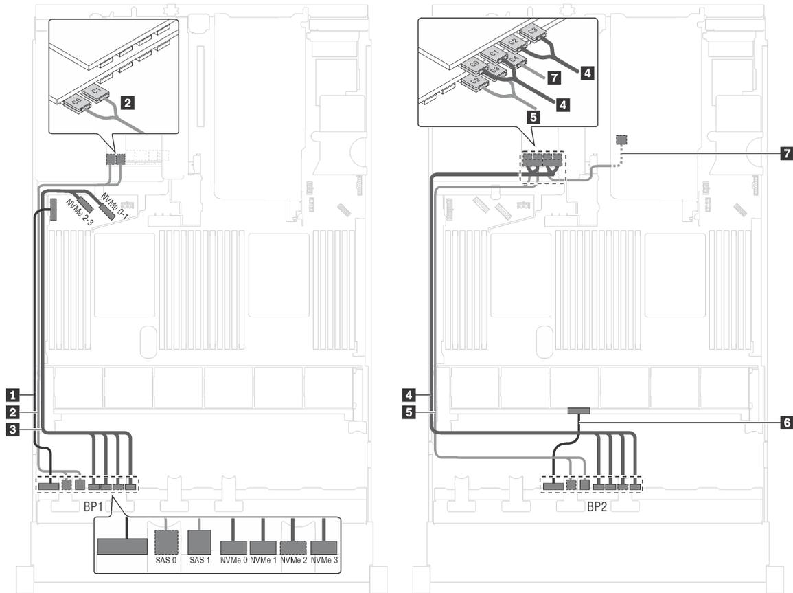
Рис. 41. Прокладка кабелей для моделей серверов с восемью 2,5-дюймовыми дисками SAS/SATA, восемью 2,5-дюймовыми дисками SAS/SATA/NVMe, задним блоком оперативно заменяемых дисков, одним адаптером RAID 24i и одним адаптером-переключателем NVMe
