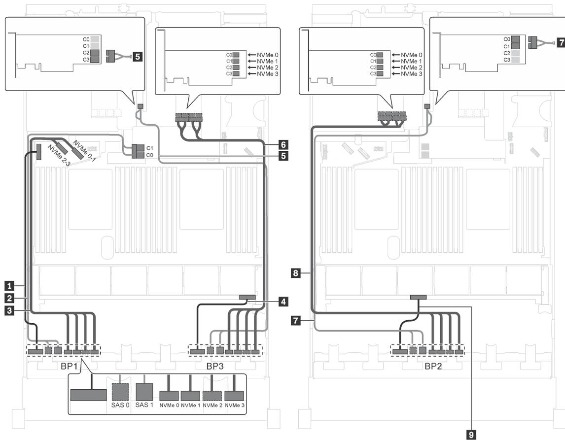
Рис. 62. Прокладка кабелей для моделей серверов с двенадцатью 2,5-дюймовыми дисками SAS/SATA, двенадцатью 2,5-дюймовыми дисками SAS/SATA/NVMe, одним адаптером RAID 8i, одним адаптером RAID 16i и двумя адаптерами-переключателями NVMe
