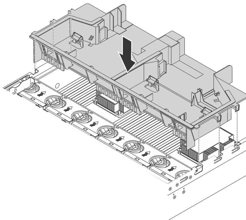
Рис. 113. Установка дефлектора большого размера
