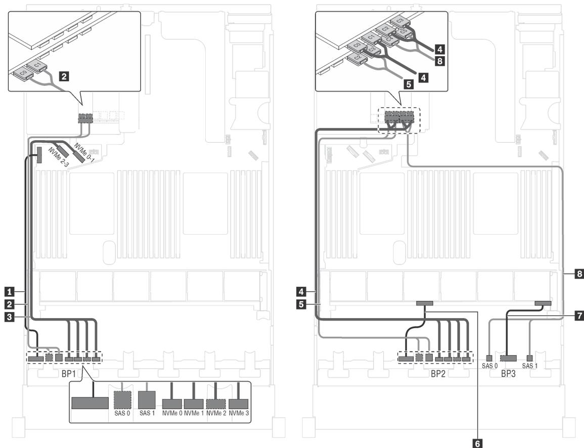
Рис. 56. Прокладка кабелей для моделей серверов с шестнадцатью 2,5-дюймовыми дисками SAS/SATA, восемью 2,5-дюймовыми дисками SAS/SATA/NVMe, одним адаптером RAID 24i и одним адаптером-переключателем NVMe
