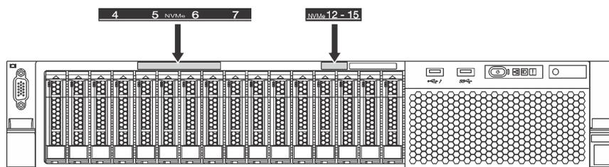
Рис. 84. Этикетки отсеков для дисков в моделях серверов с установленными объединительными панелями с 8 отсеками ApyBay
