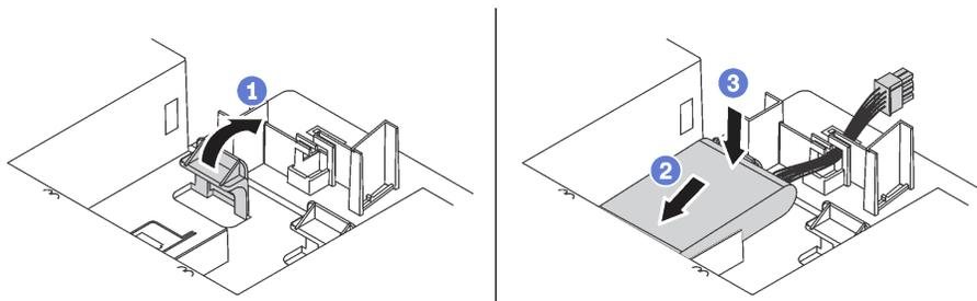
Рис. 114. Установка модуля суперконденсатора RAID
