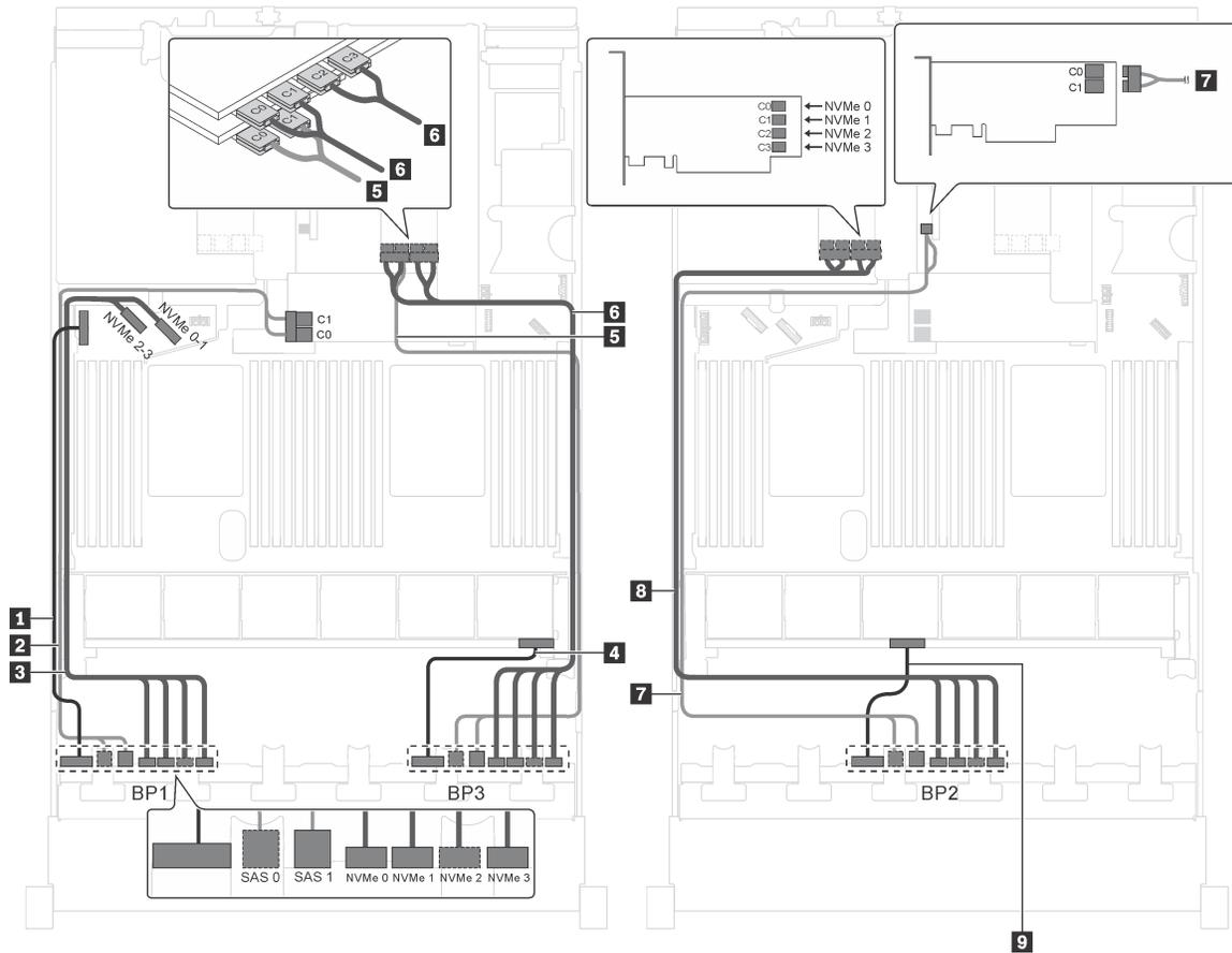
Рис. 61. Прокладка кабелей для моделей серверов с двенадцатью 2,5-дюймовыми дисками SAS/SATA, двенадцатью 2,5-дюймовыми дисками SAS/SATA/NVMe, тремя адаптерами RAID 8i и двумя адаптерами-переключателями NVMe
