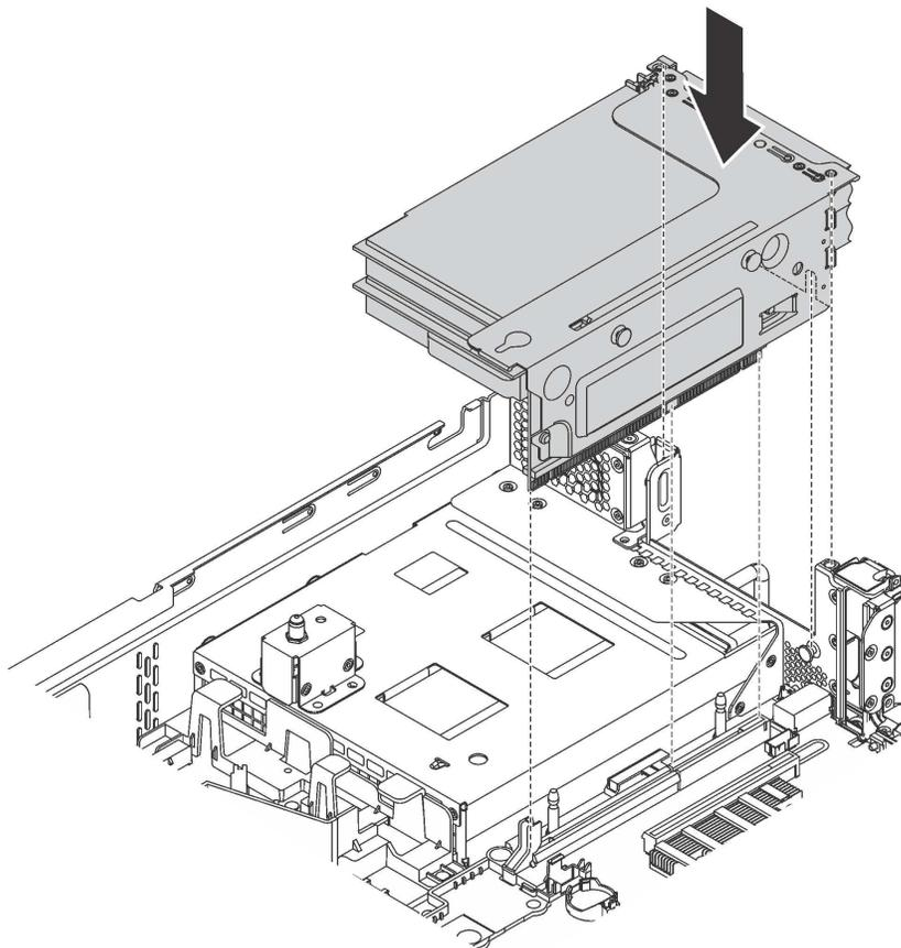
Рис. 103. Установка блока платы-адаптера Riser 2
