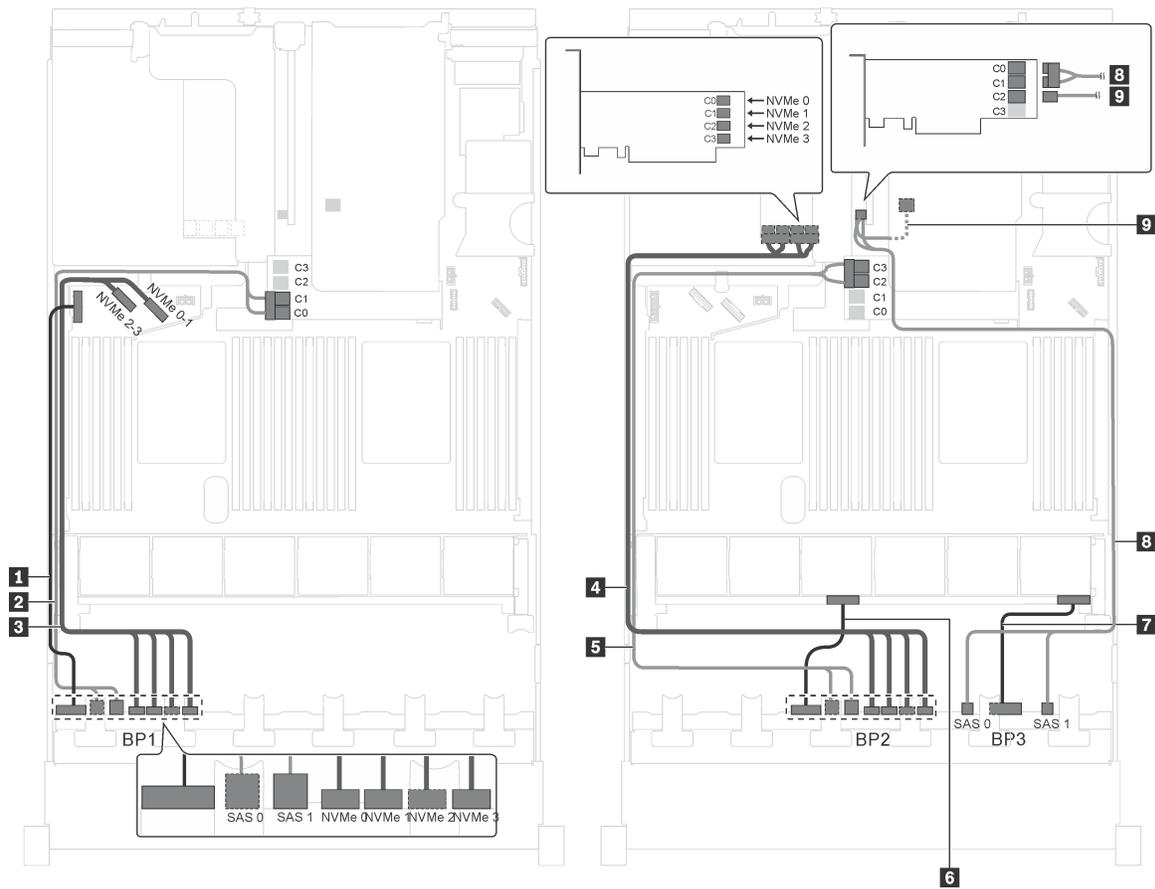
Рис. 58. Прокладка кабелей для моделей серверов с шестнадцатью 2,5-дюймовыми дисками SAS/SATA, восемью 2,5-дюймовыми дисками SAS/SATA/NVMe, задним блоком оперативно заменяемых дисков, двумя адаптерами RAID 16i и одним адаптером-переключателем NVMe
