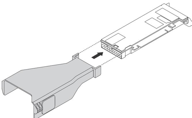
Рис. 97. Установка дефлектора графического процессора P4
