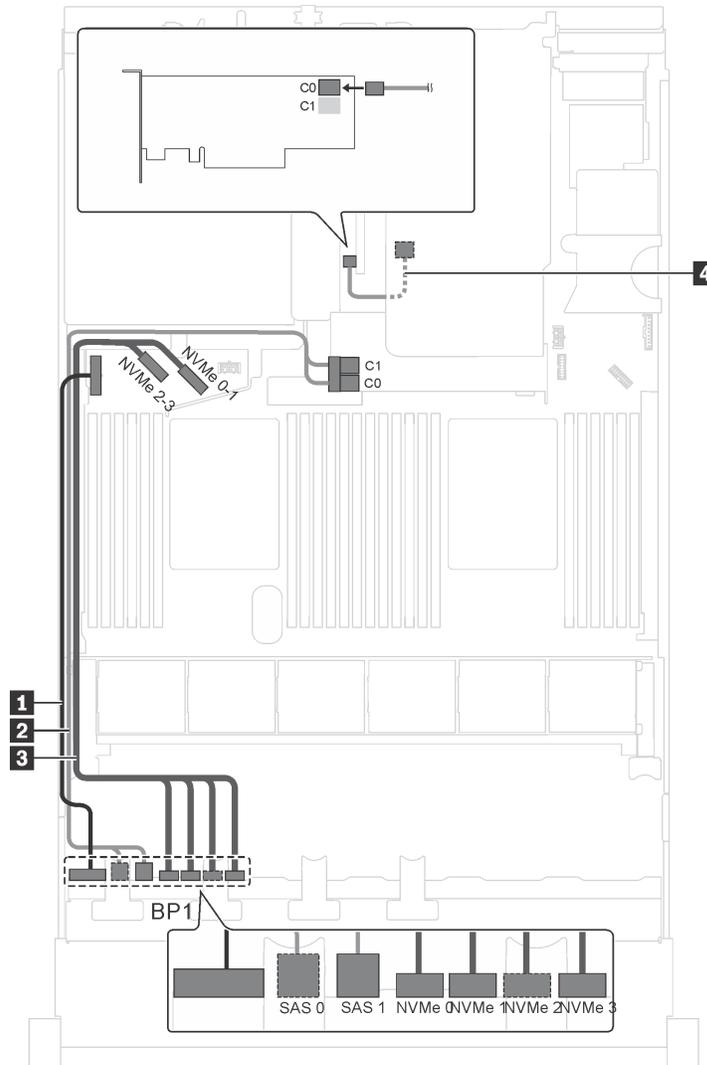
Рис. 26. Прокладка кабелей для моделей серверов с четырьмя 2,5-дюймовыми дисками SAS/SATA, четырьмя 2,5-дюймовыми дисками SAS/SATA/NVMe, задним блоком оперативно заменяемых дисков и двумя адаптерами RAID 8i
