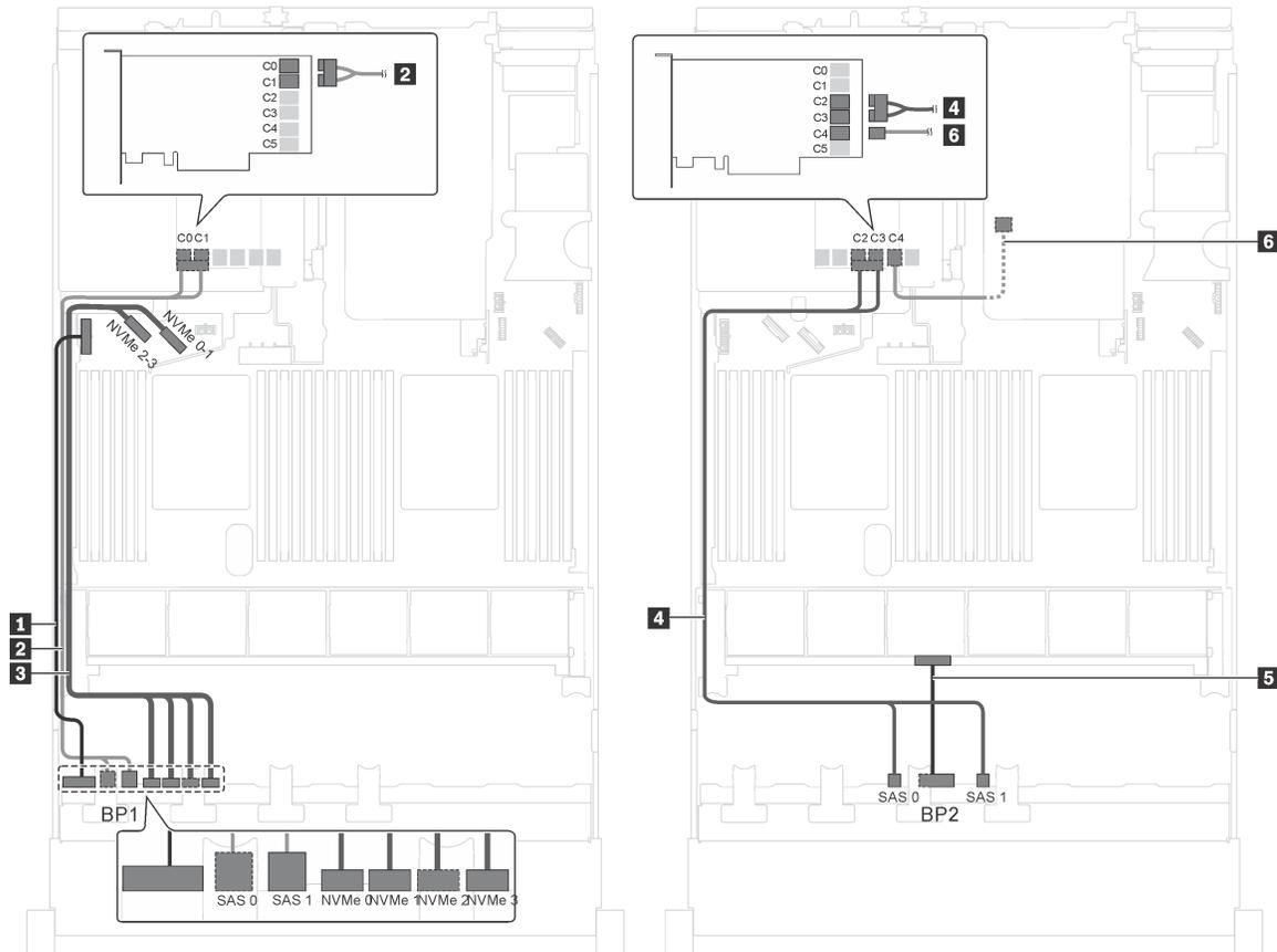
Рис. 37. Прокладка кабелей для моделей серверов с двенадцатью 2,5-дюймовыми дисками SAS/SATA, четырьмя 2,5-дюймовыми дисками SAS/SATA/NVMe, задним блоком оперативно заменяемых дисков и одним адаптером RAID 24i
