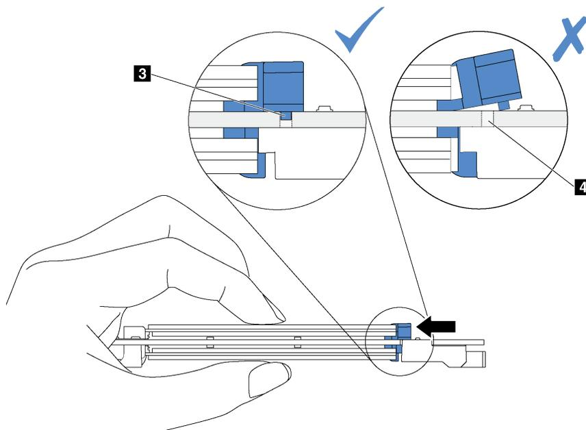
Рис. 91. Инструкция по перемещению фиксатора
