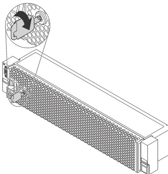
Рис. 73. Разблокирование защитной панели
