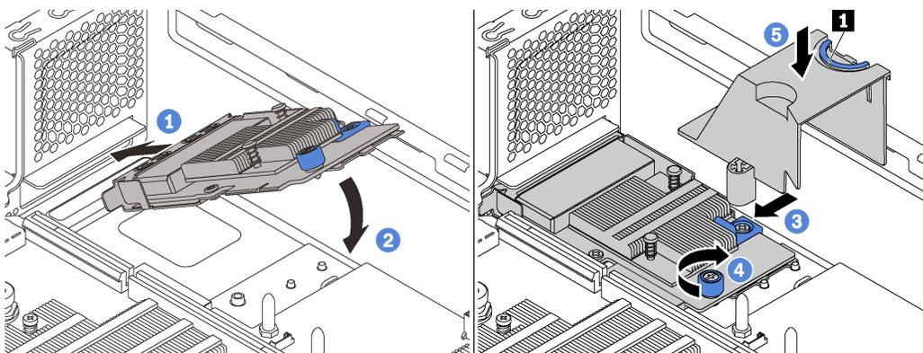
Рис. 105. Установка адаптера LOM
