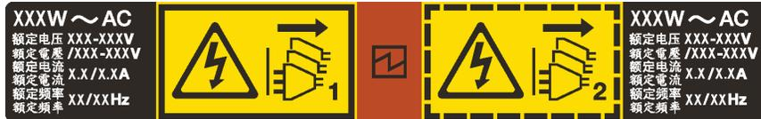
Рис. 109. Этикетка оперативно заменяемого блока питания на крышке
