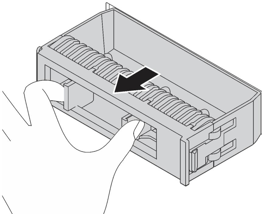
Рис. 117. Снятие заглушки 3,5-дюймового диска
