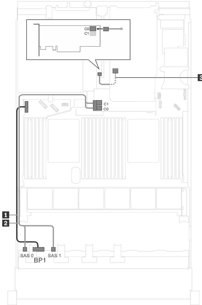
Рис. 23. Прокладка кабелей для моделей серверов с восемью 2,5-дюймовыми дисками SAS/SATA, задним блоком оперативно заменяемых дисков и двумя адаптерами RAID 8i
