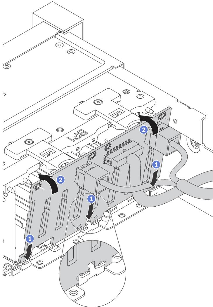
Рис. 83. Установка объединительной панели для 2,5-дюймовых дисков
