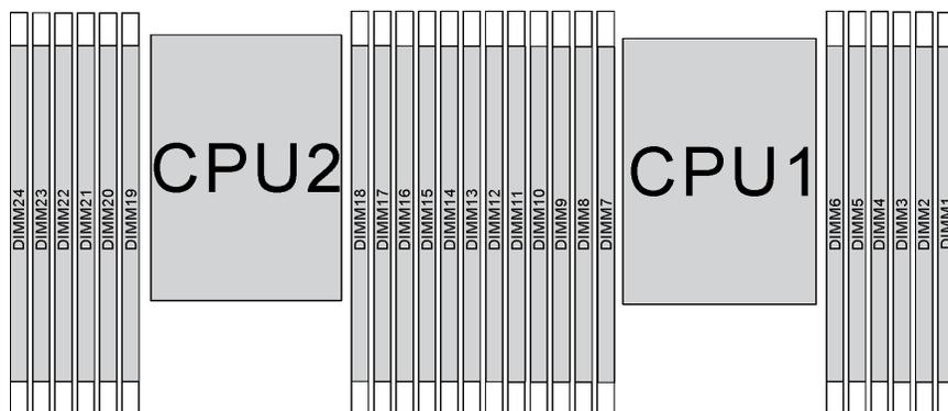
Рис. 82. гнезда модулей памяти на материнской плате
