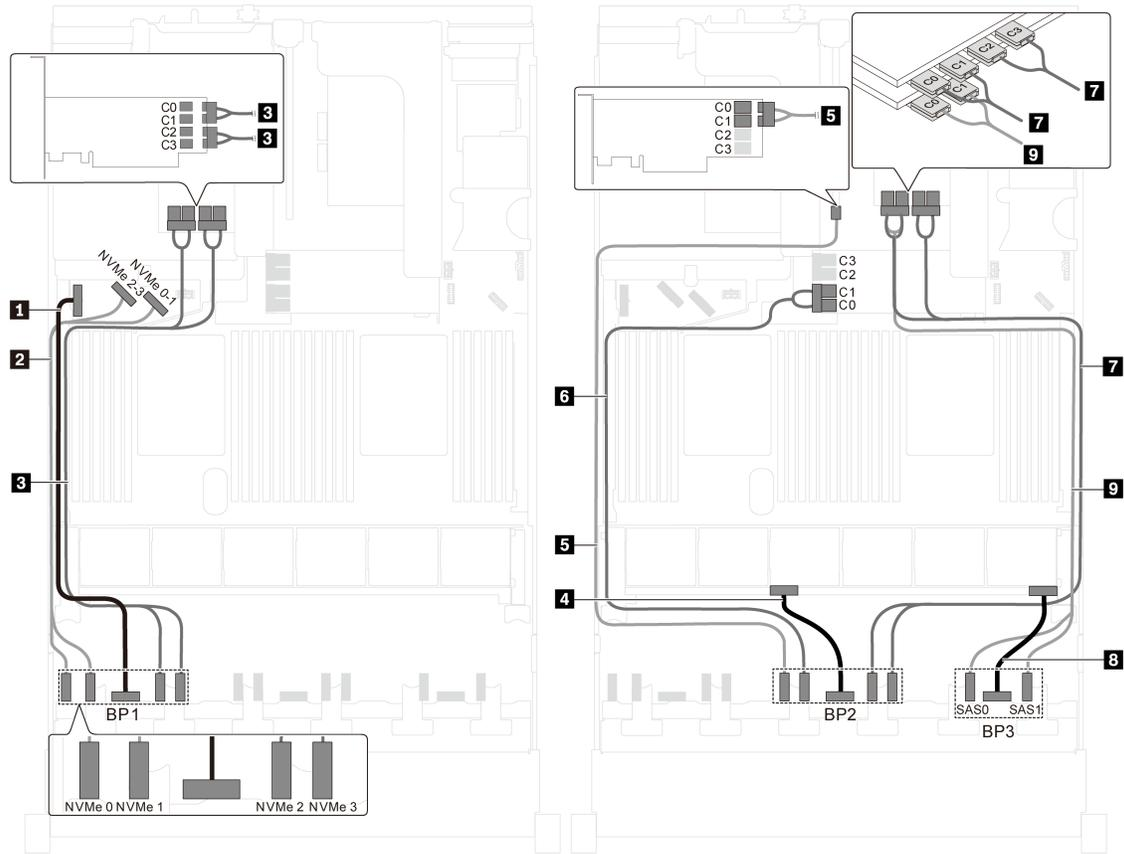
Рис. 63. Прокладка кабелей для моделей серверов с шестнадцатью 2,5-дюймовыми дисками NVMe, восемью дисками SAS/SATA, двумя адаптерами-переключателями NVMe 810-4P, двумя адаптерами-переключателями NVMe 1610-4P и одним адаптером RAID 8i
