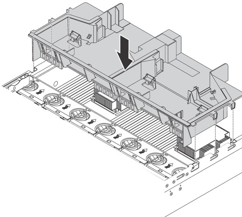
Рис. 95. Установка дефлектора большого размера
