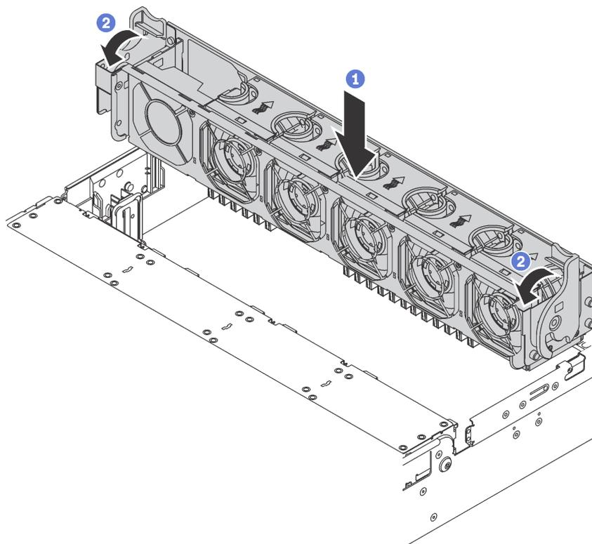
Рис. 107. Установка отсека вентиляторов компьютера
