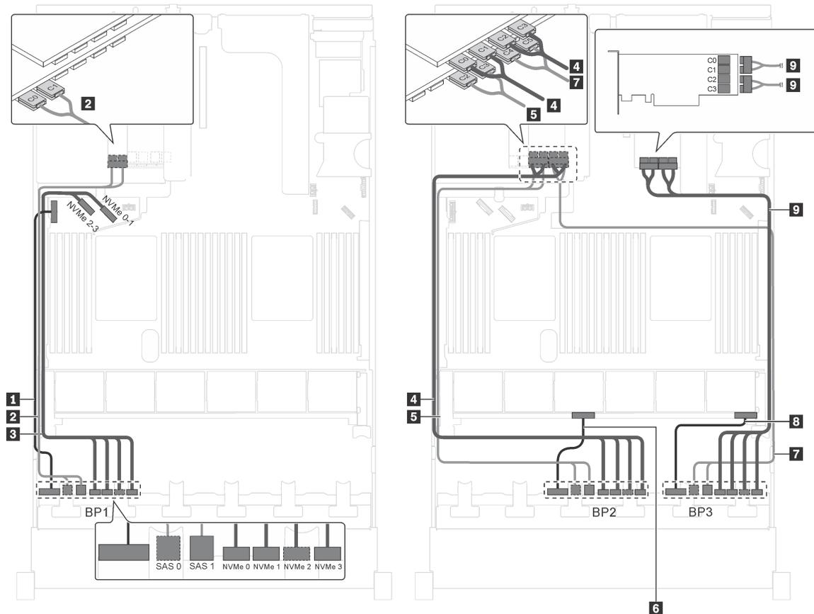
Рис. 60. Прокладка кабелей для моделей серверов с двенадцатью 2,5-дюймовыми дисками SAS/SATA, двенадцатью 2,5-дюймовыми дисками SAS/SATA/NVMe, одним адаптером RAID 24i и двумя адаптерами-переключателями NVMe
