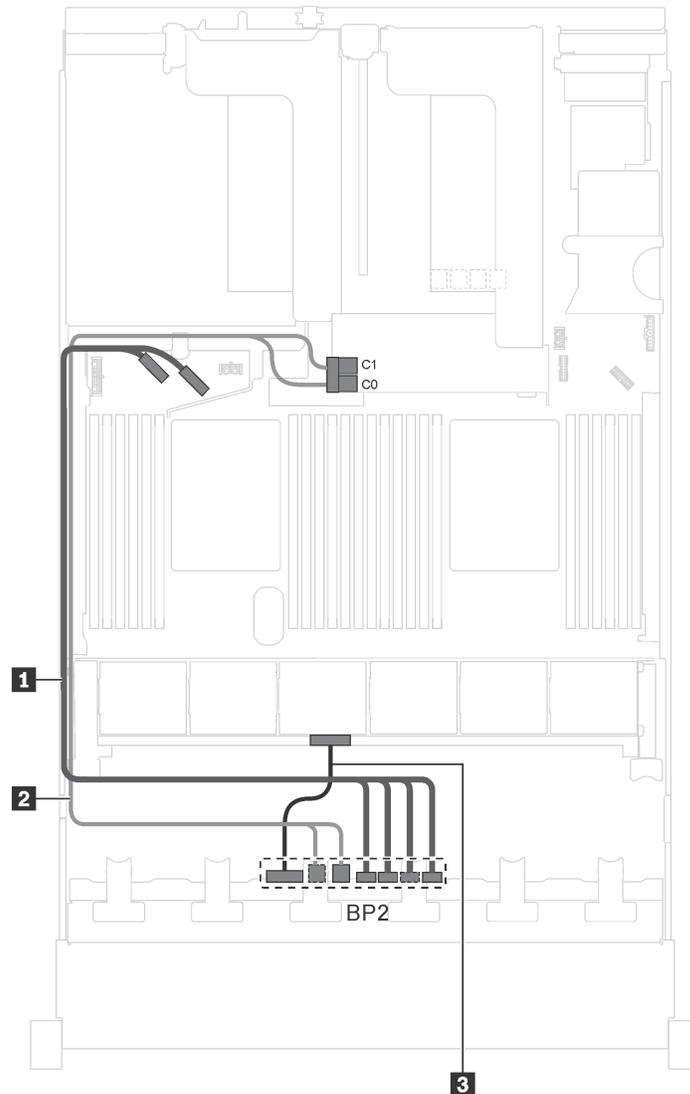
*Рис. 29. Прокладка кабелей для моделей серверов с четырьмя 2,5-дюймовыми дисками SAS/SATA, четырьмя 2,5-дюймовыми дисками SAS/SATA/NVMe, процессорами Intel Xeon 6137, 6242R, 6246R, 6248R, 6250, 6256 или 6258R и одним адаптером RAID 8i*
