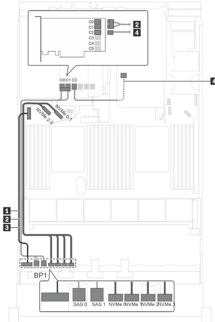
Рис. 28. Прокладка кабелей для моделей серверов с четырьмя 2,5-дюймовыми дисками SAS/SATA, четырьмя 2,5-дюймовыми дисками SAS/SATA/NVMe, задним блоком оперативно заменяемых дисков и одним адаптером RAID 24i
