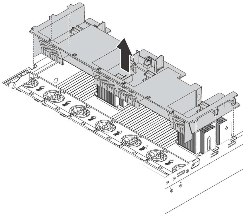
Рис. 76. Снятие стандартного дефлектора
