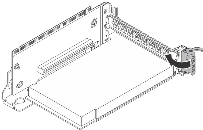
Рис. 101. Закрывание фиксирующей защелки PCIe
