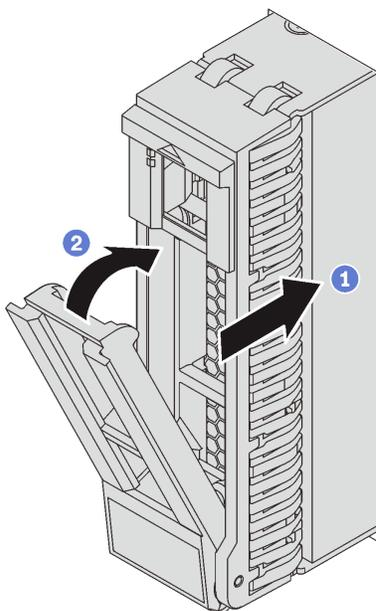
Рис. 118. Установка 2,5-дюймового оперативно заменяемого диска
