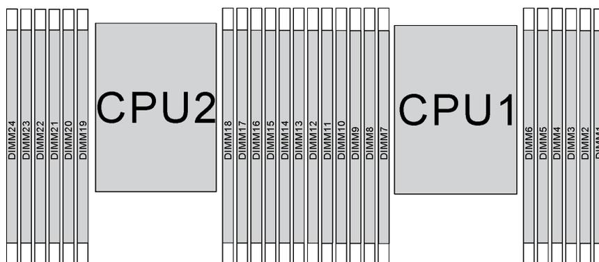
Рис. 81. гнезда модулей памяти на материнской плате
