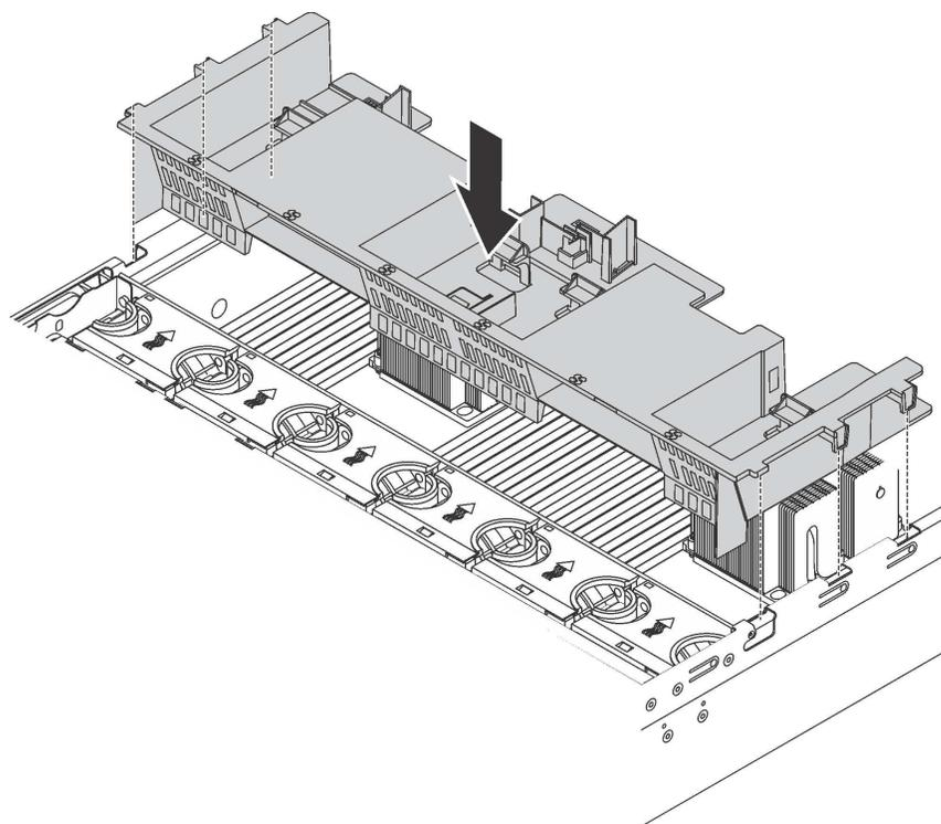
Рис. 112. Установка стандартного дефлектора
