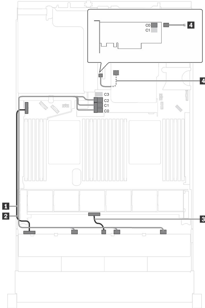
Рис. 68. Прокладка кабелей для моделей серверов с двенадцатью 3,5-дюймовыми дисками SAS/SATA, задним блоком оперативно заменяемых дисков, одним адаптером RAID 8i и одним адаптером RAID 16i
