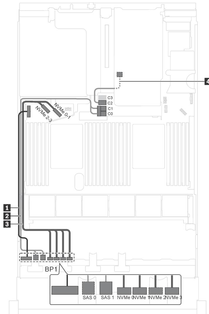
Рис. 27. Прокладка кабелей для моделей серверов с четырьмя 2,5-дюймовыми дисками SAS/SATA, четырьмя 2,5-дюймовыми дисками SAS/SATA/NVMe, задним блоком оперативно заменяемых дисков и одним адаптером RAID 16i
