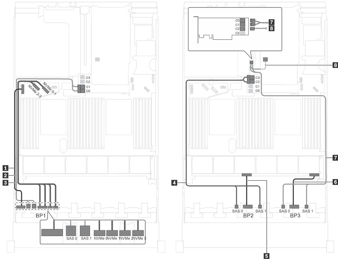
Рис. 55. Прокладка кабелей для моделей серверов с двадцатью 2,5-дюймовыми дисками SAS/SATA, четырьмя 2,5-дюймовыми дисками SAS/SATA/NVMe, задним блоком оперативно заменяемых дисков и двумя адаптерами RAID 16i
