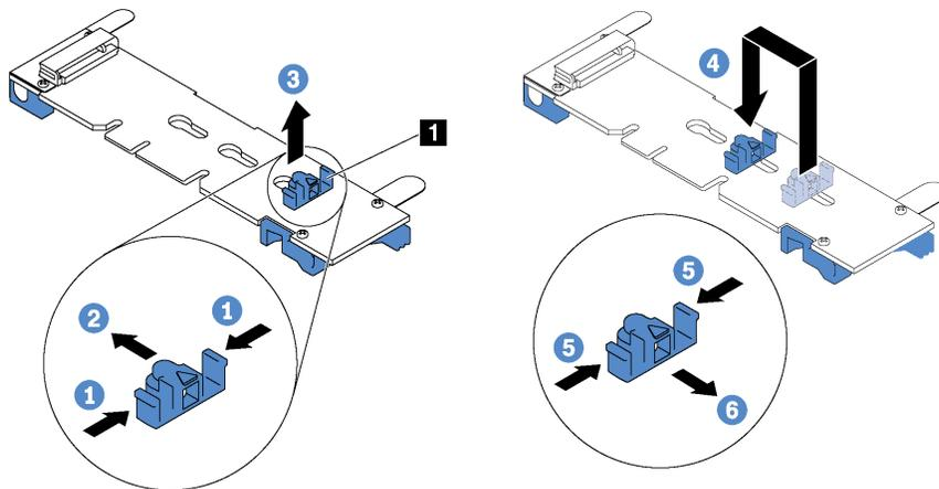
Рис. 94. Регулировка фиксатора M.2
