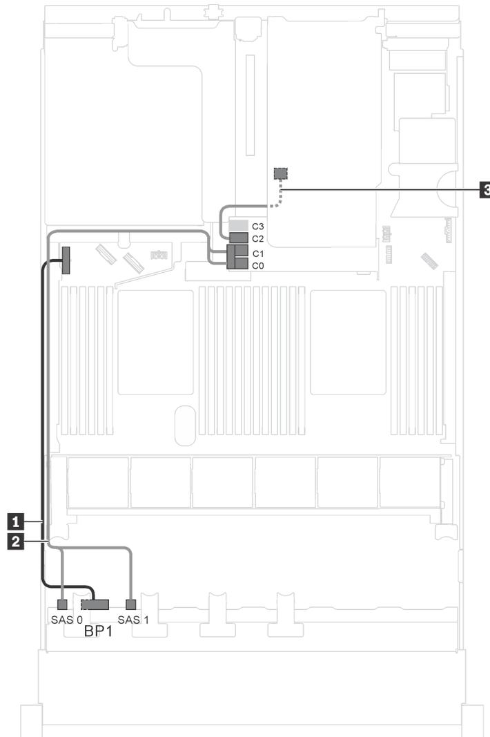
Рис. 21. Прокладка кабелей для моделей серверов с восемью 2,5-дюймовыми дисками SAS/SATA, задним блоком оперативно заменяемых дисков и одним адаптером RAID 16i
