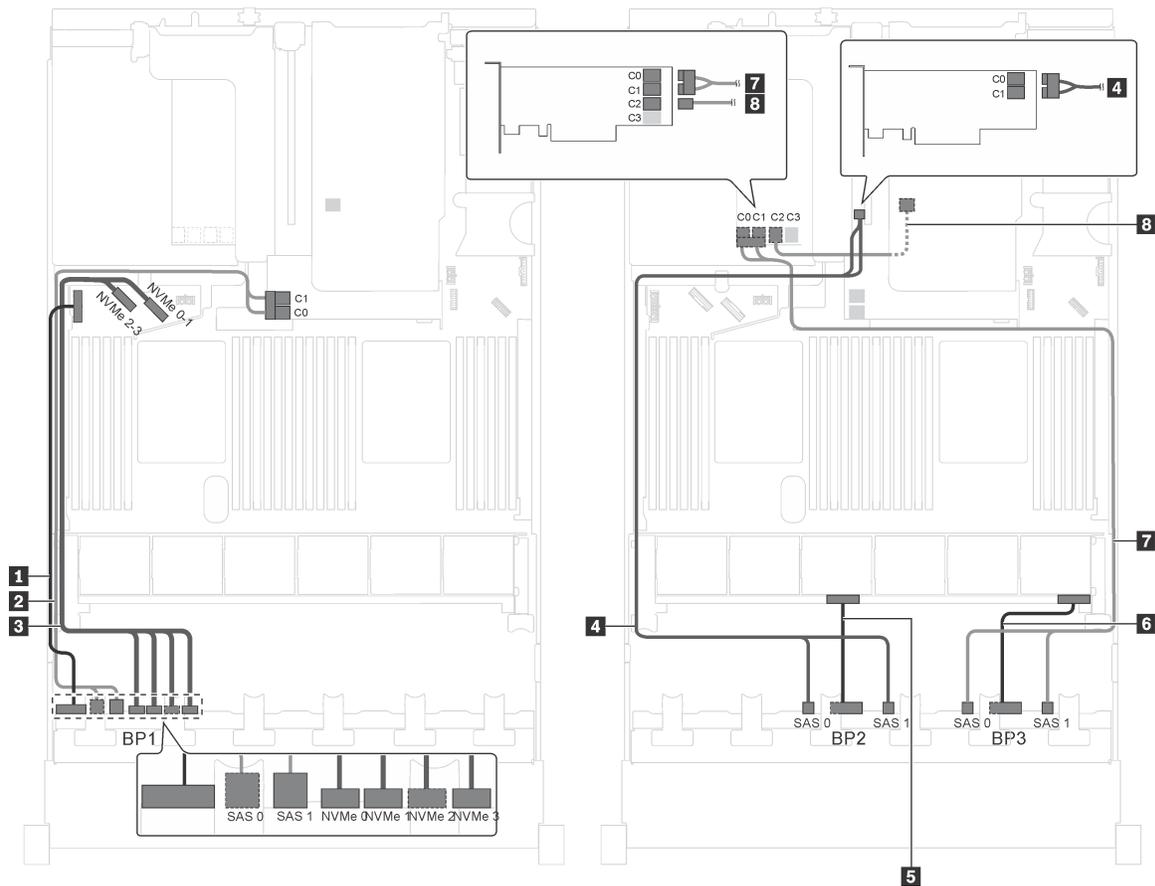
Рис. 53. Прокладка кабелей для моделей серверов с двадцатью 2,5-дюймовыми дисками SAS/SATA, четырьмя 2,5-дюймовыми дисками SAS/SATA/NVMe, задним блоком оперативно заменяемых дисков, двумя адаптерами RAID 8i и одним адаптером RAID 16i
