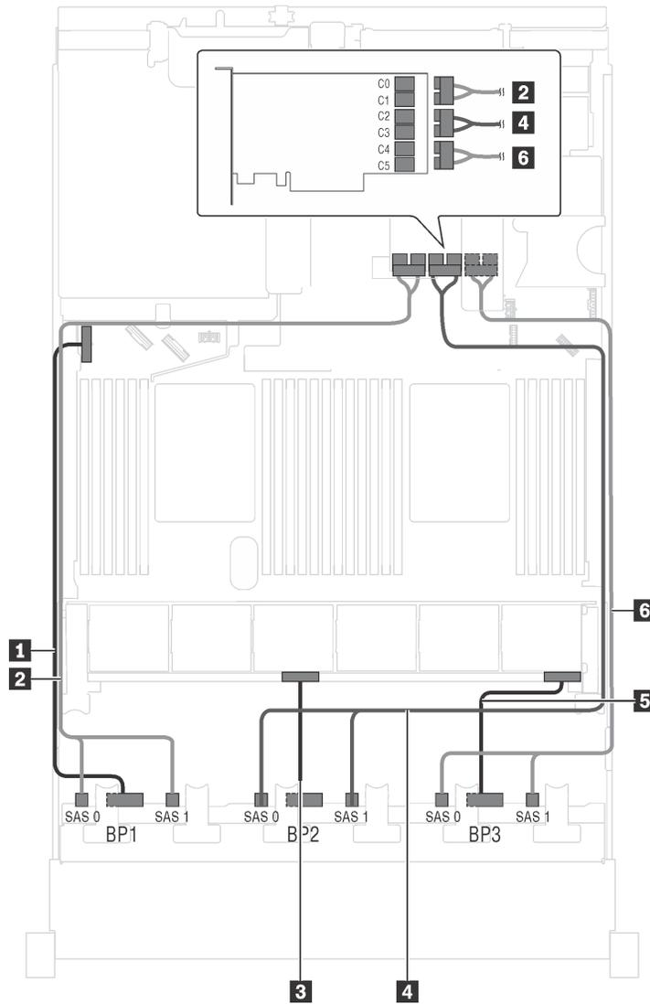
Рис. 45. Прокладка кабелей для моделей серверов с двадцатью четырьмя 2,5-дюймовыми дисками SAS/SATA и одним адаптером 24i RAID
