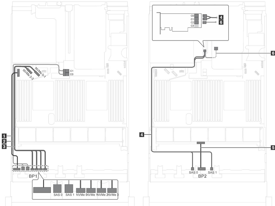
Рис. 36. Прокладка кабелей для моделей серверов с двенадцатью 2,5-дюймовыми дисками SAS/SATA, четырьмя 2,5-дюймовыми дисками SAS/SATA/NVMe, задним блоком оперативно заменяемых дисков, одним адаптером RAID 8i и одним адаптером RAID 16i
