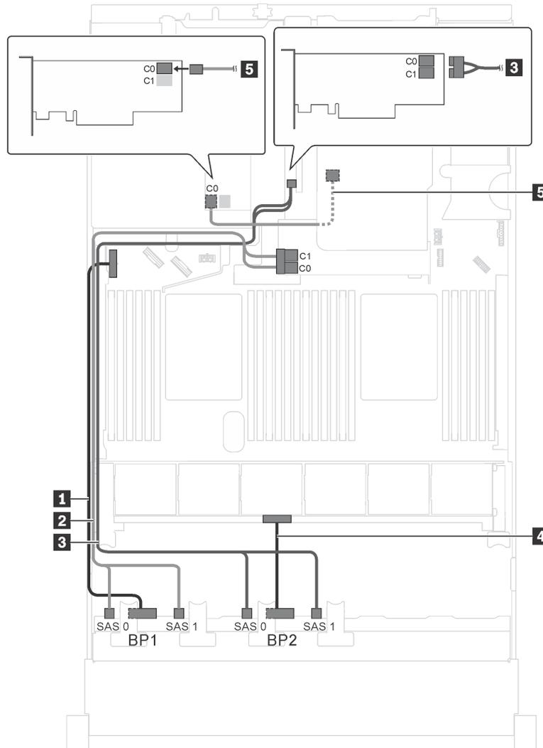
Рис. 33. Прокладка кабелей для моделей серверов с шестнадцатью 2,5-дюймовыми дисками SAS/SATA, задним блоком оперативно заменяемых дисков и тремя адаптерами RAID 8i
