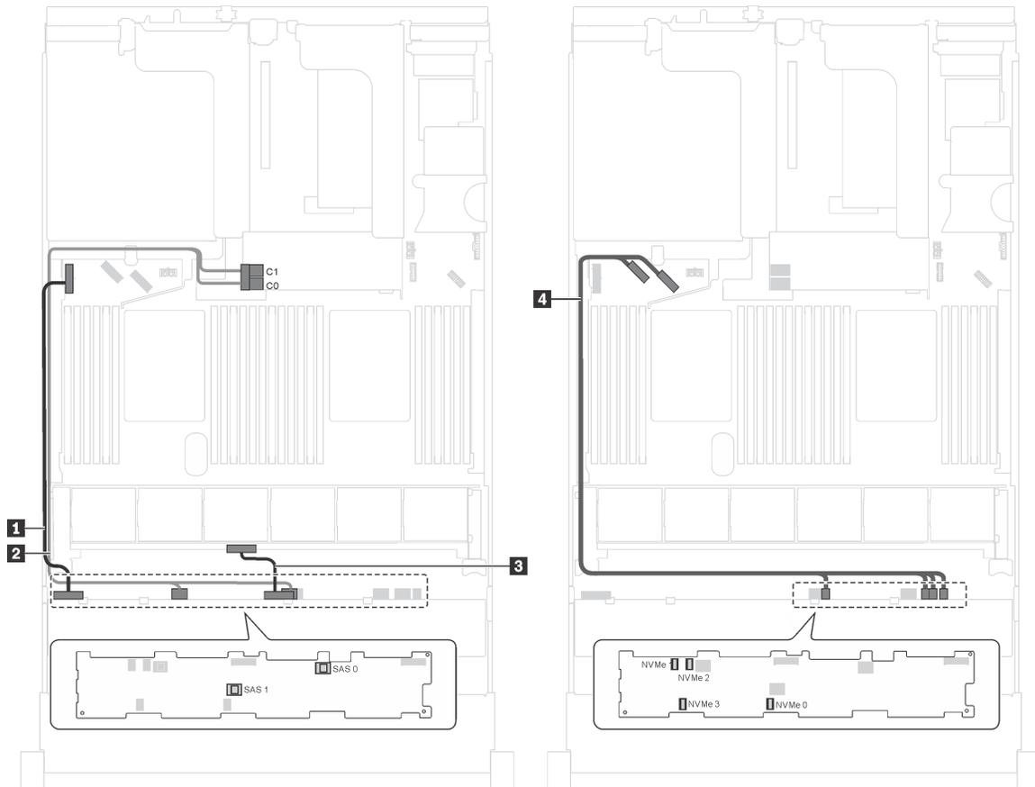
Рис. 70. Прокладка кабелей для моделей серверов с восемью 3,5-дюймовыми дисками SAS/SATA, четырьмя 3,5-дюймовыми дисками NVMe и одним адаптером RAID 8i
