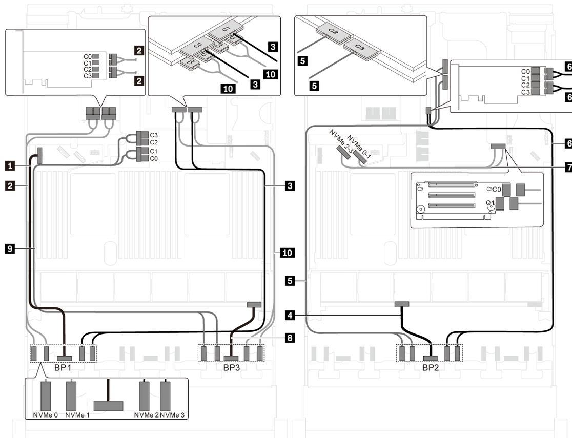
Рис. 64. Прокладка кабелей для моделей серверов с двадцатью четырьмя 2,5-дюймовыми дисками NVMe, четырьмя адаптерами-переключателями NVMe 810-4P и одним адаптером-переключателем NVMe 1610-8P
