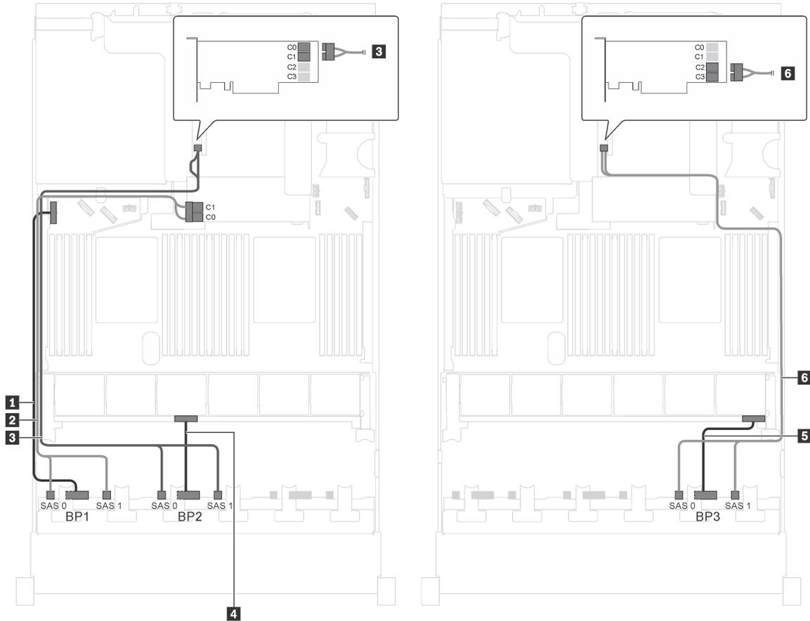
Рис. 44. Прокладка кабелей для моделей серверов с двадцатью четырьмя 2,5-дюймовыми дисками SAS/SATA, одним адаптером RAID 8i и одним адаптером RAID 16i
