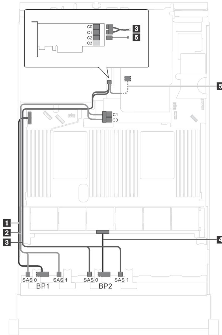
*Рис. 31. Прокладка кабелей для моделей серверов с шестнадцатью 2,5-дюймовыми дисками SAS/SATA, задним блоком оперативно заменяемых дисков, одним адаптером RAID 8i и одним адаптером RAID 16i*
