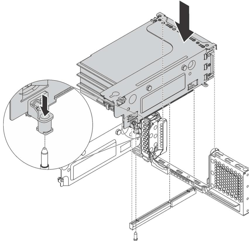
Рис. 102. Установка блока платы-адаптера Riser 1
