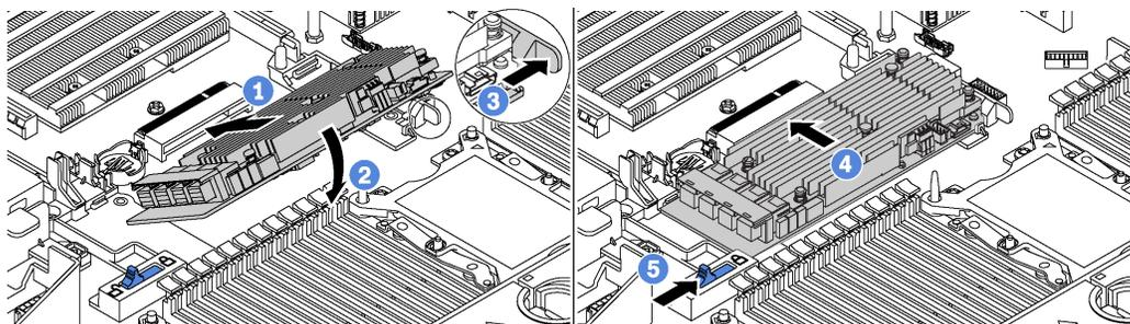
Рис. 88. Установка адаптера RAID
