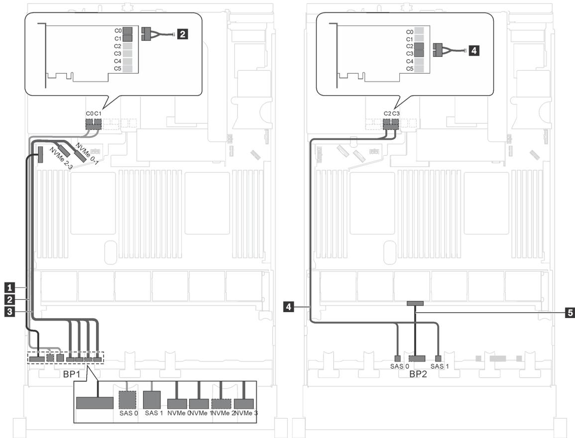
Рис. 35. Прокладка кабелей для моделей серверов с двенадцатью 2,5-дюймовыми дисками SAS/SATA, четырьмя 2,5-дюймовыми дисками SAS/SATA/NVMe и одним адаптером RAID 24i
