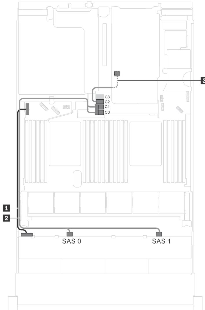
Рис. 66. Прокладка кабелей для моделей серверов с восемью 3,5-дюймовыми дисками SAS/SATA, задним блоком оперативно заменяемых дисков и одним адаптером RAID 16i
