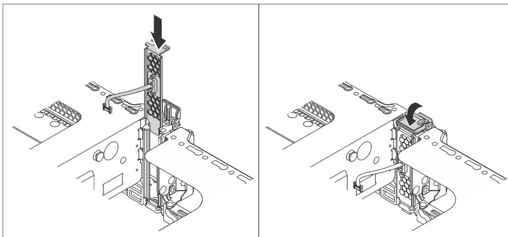
Рис. 106. Установка модуля последовательного порта
