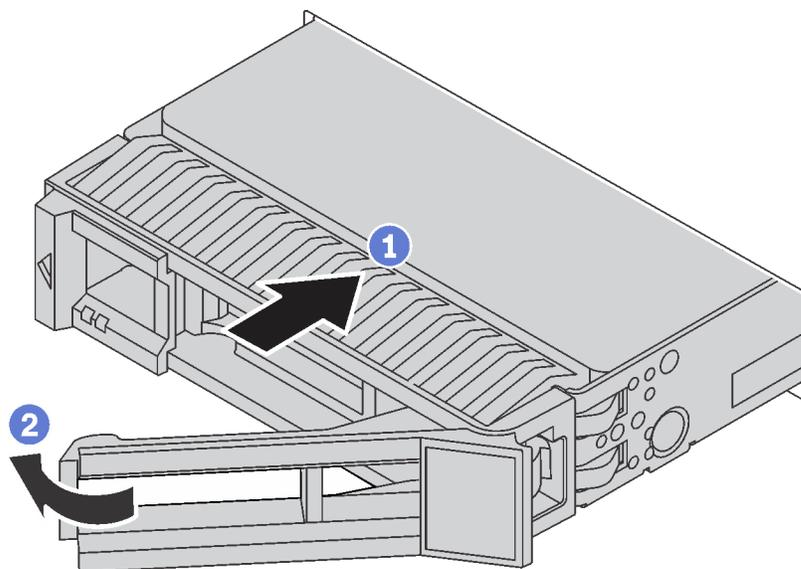
Рис. 119. Установка 3,5-дюймового оперативно заменяемого диска
