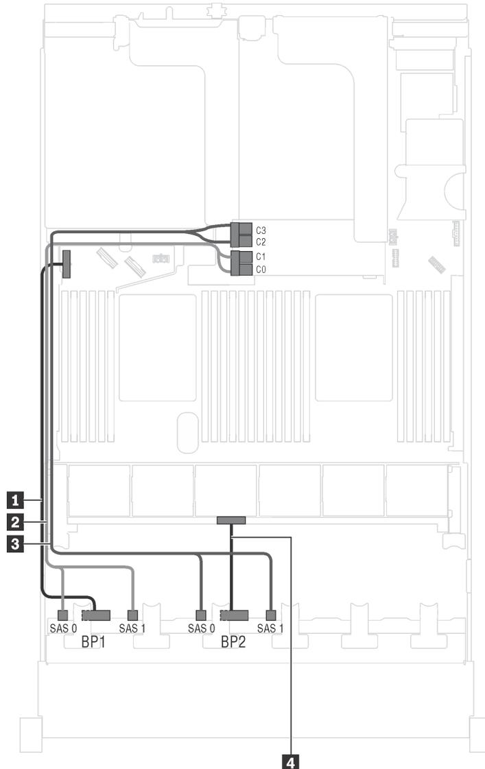
Рис. 30. Прокладка кабелей для моделей серверов с шестнадцатью 2,5-дюймовыми дисками SAS/SATA и одним адаптером 16i RAID
