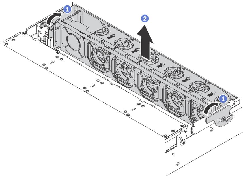
Рис. 78. Снятие отсека вентиляторов компьютера
