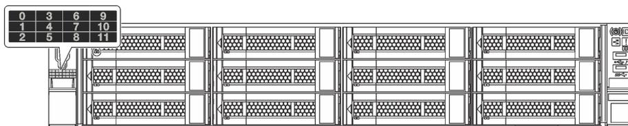
Рис. 86. Этикетка отсека для диска в моделях серверов с установленной объединительной панелью с 12 отсеками
