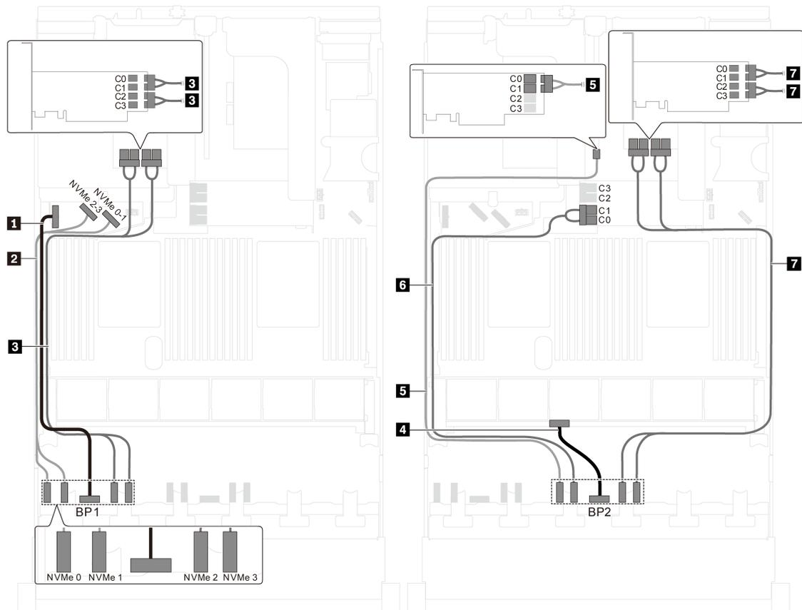
Рис. 42. Прокладка кабелей для моделей серверов с шестнадцатью 2,5-дюймовыми дисками NVMe, двумя адаптерами-переключателями NVMe 810-4P и двумя адаптерами-переключателями NVMe 1610-4P
