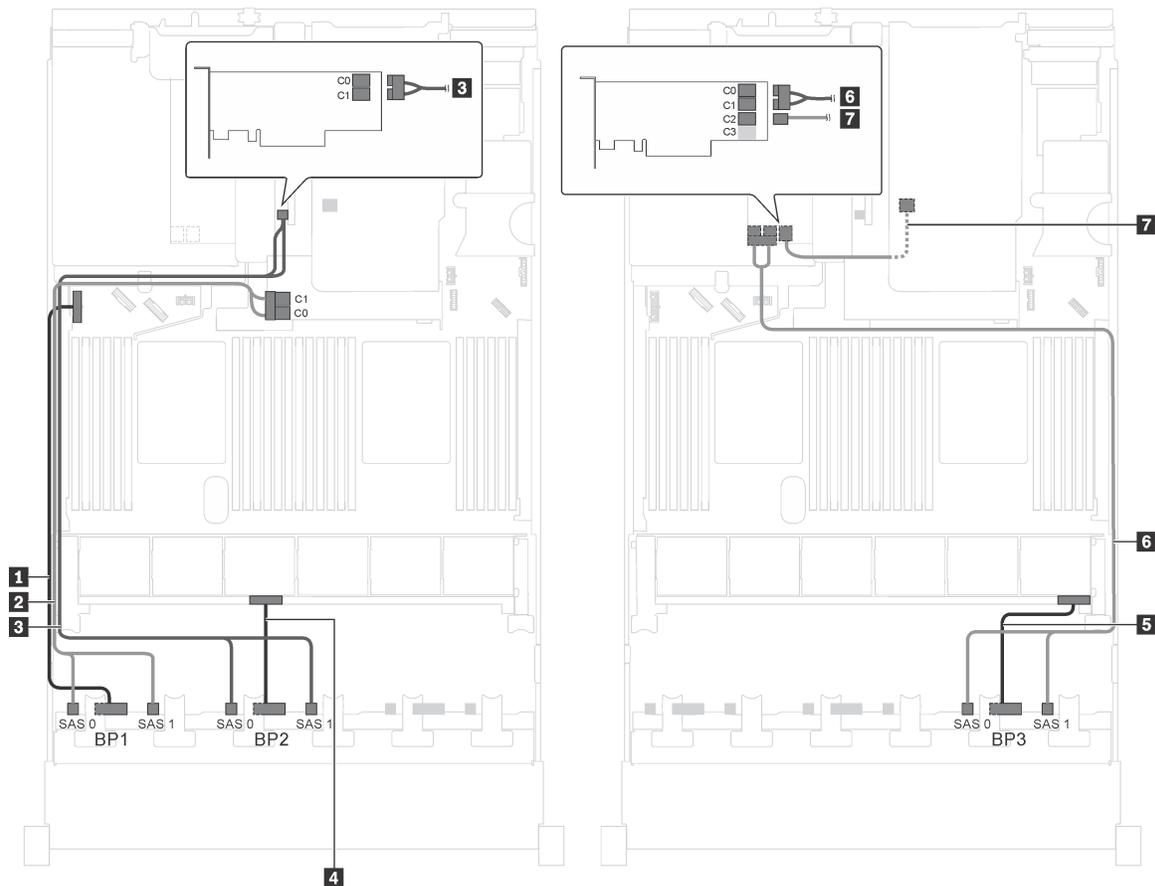
Рис. 47. Прокладка кабелей для моделей серверов с двадцатью четырьмя 2,5-дюймовыми дисками SAS/SATA, задним блоком оперативно заменяемых дисков, двумя адаптерами RAID 8i и одним адаптером RAID 16i
