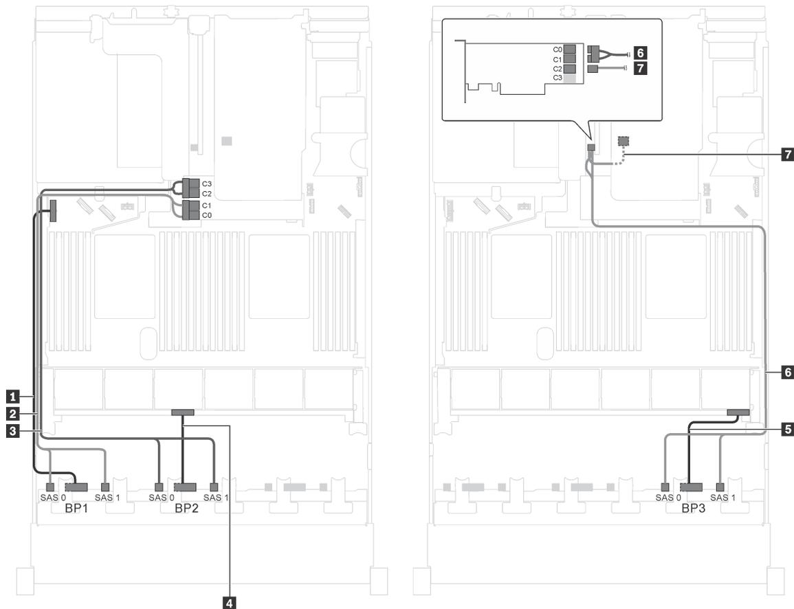
Рис. 49. Прокладка кабелей для моделей серверов с двадцатью четырьмя 2,5-дюймовыми дисками SAS/SATA, задним блоком оперативно заменяемых дисков и двумя адаптерами RAID 16i
