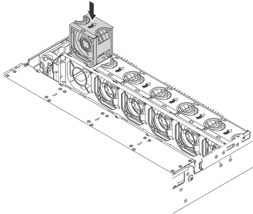
Рис. 108. Установка вентилятора компьютера
