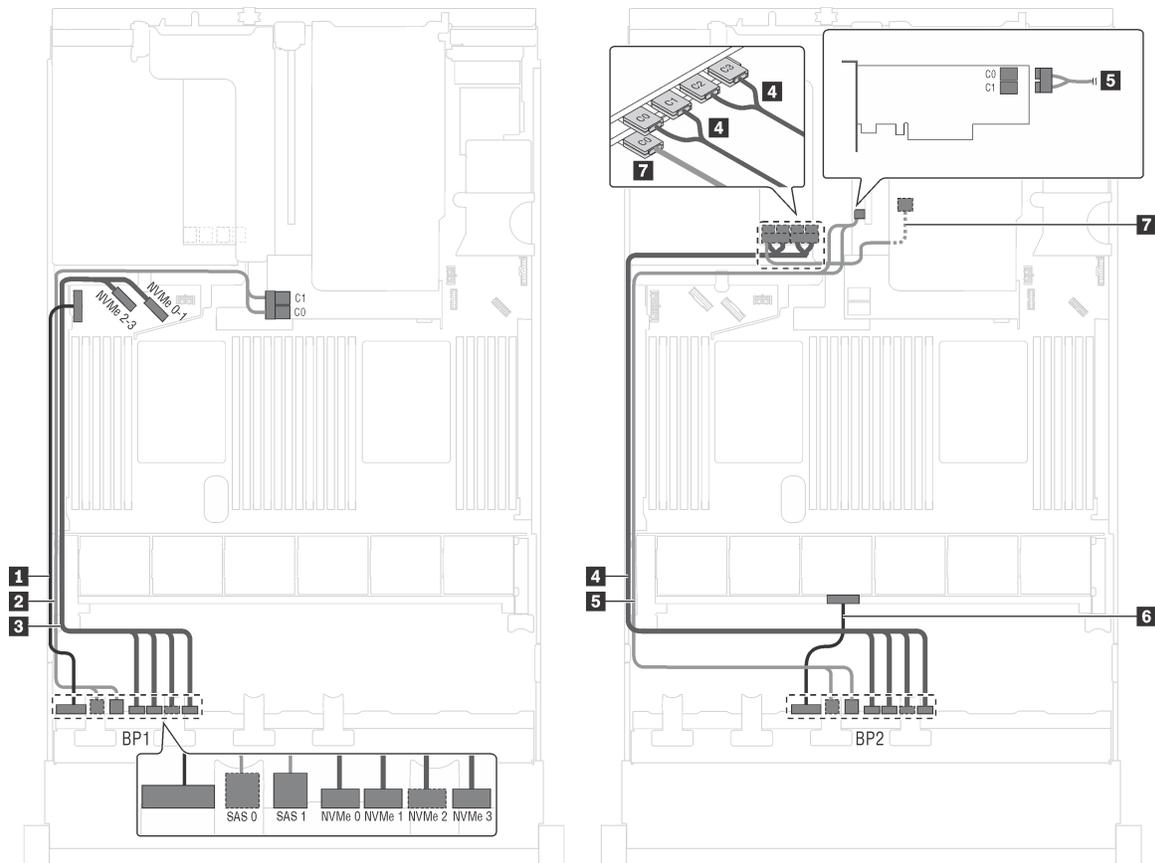
*Рис. 40. Прокладка кабелей для моделей серверов с восемью 2,5-дюймовыми дисками SAS/SATA, восемью 2,5-дюймовыми дисками SAS/SATA/NVMe, задним блоком оперативно заменяемых дисков, тремя адаптерами RAID 8i и одним адаптером-переключателем NVMe*
