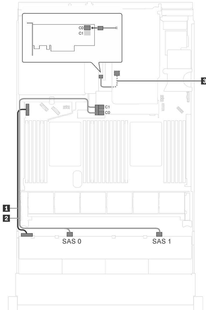
Рис. 65. Прокладка кабелей для моделей серверов с восемью 3,5-дюймовыми дисками SAS/SATA, задним блоком оперативно заменяемых дисков и двумя адаптерами RAID 8i
