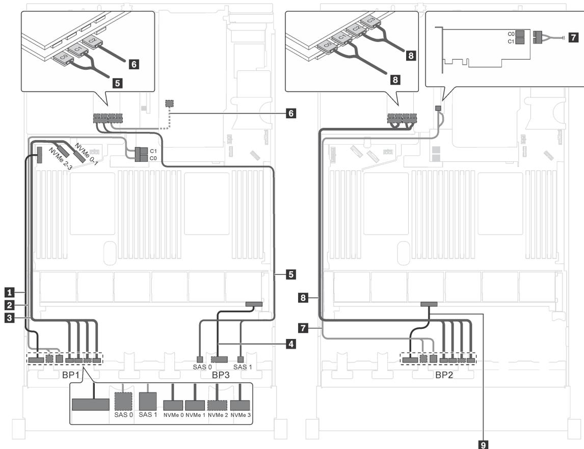
Рис. 59. Прокладка кабелей для моделей серверов с шестнадцатью 2,5-дюймовыми дисками SAS/SATA, восемью 2,5-дюймовыми дисками SAS/SATA/NVMe, задним блоком оперативно заменяемых дисков, двумя адаптерами RAID 8i, одним адаптером RAID 16i и одним адаптером-переключателем NVMe
