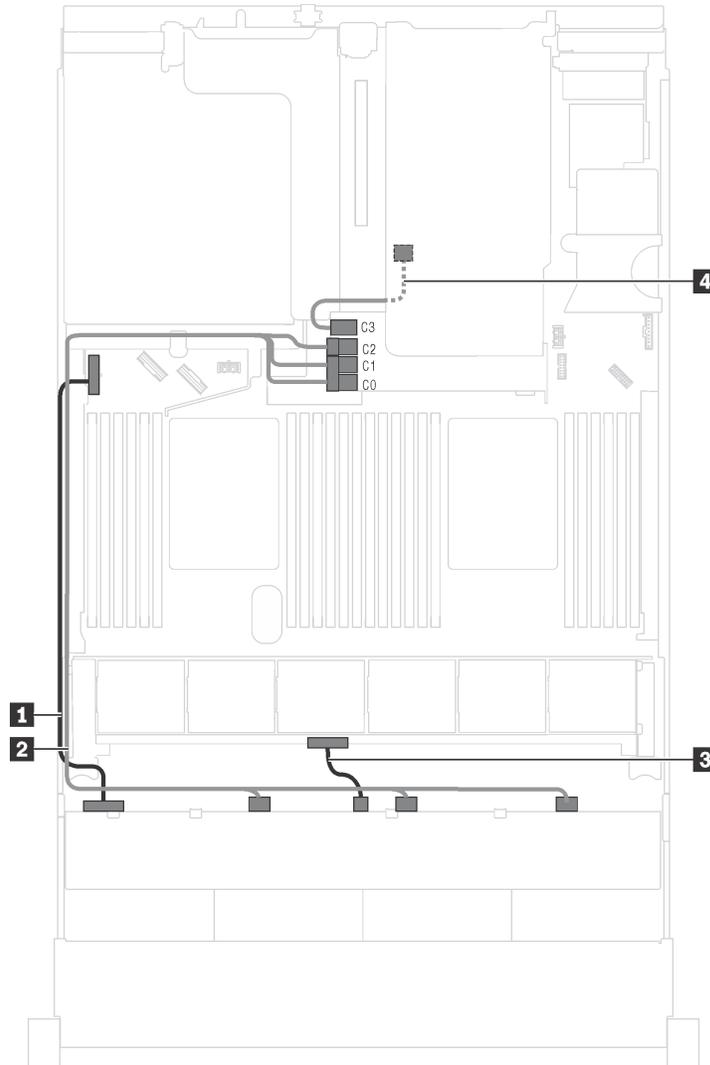
Рис. 67. Прокладка кабелей для моделей серверов с двенадцатью 3,5-дюймовыми дисками SAS/SATA, задним блоком оперативно заменяемых дисков и одним адаптером RAID 16i
