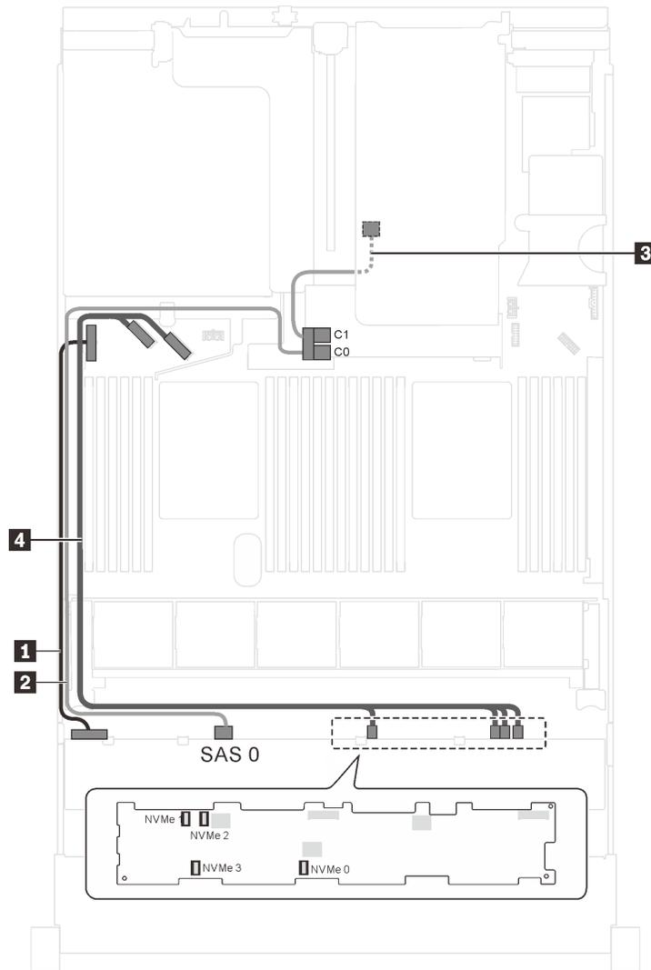
Рис. 71. Прокладка кабелей для моделей серверов с восемью 3,5-дюймовыми дисками SAS/SATA, четырьмя 3,5-дюймовыми дисками NVMe, задним блоком оперативно заменяемых дисков и одним адаптером RAID 8i
