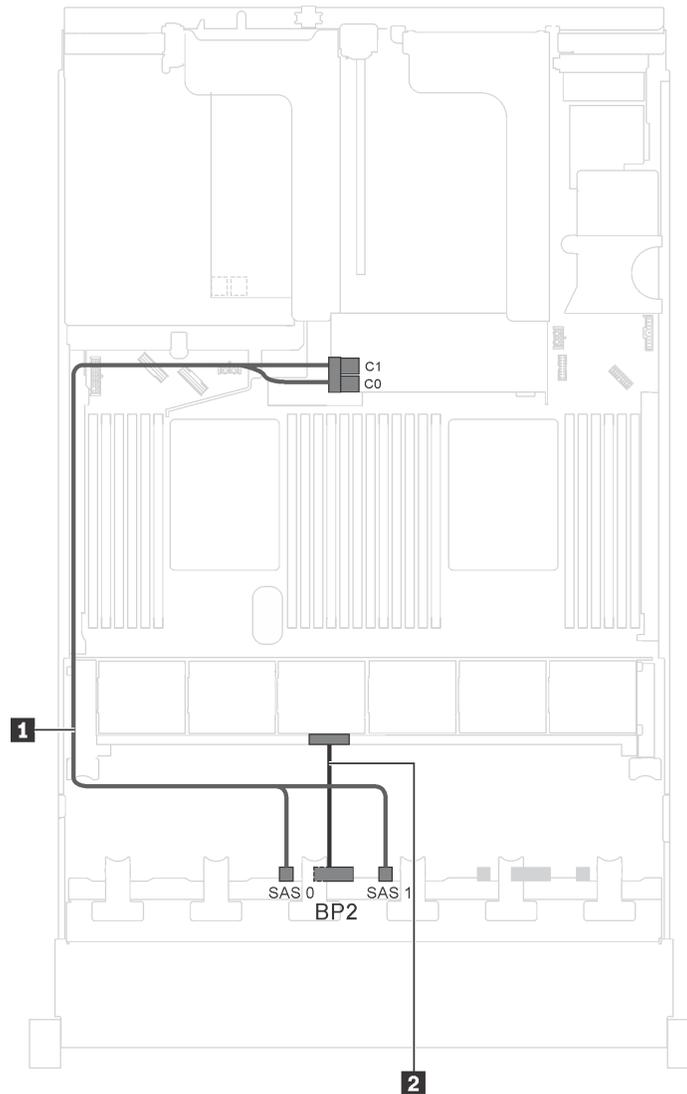
*Рис. 25. Прокладка кабелей для моделей серверов с восемью 2,5-дюймовыми дисками SAS/SATA, процессорами Intel Xeon 6137, 6242R, 6246R, 6248R, 6250, 6256 или 6258R и одним адаптером RAID 8i*
