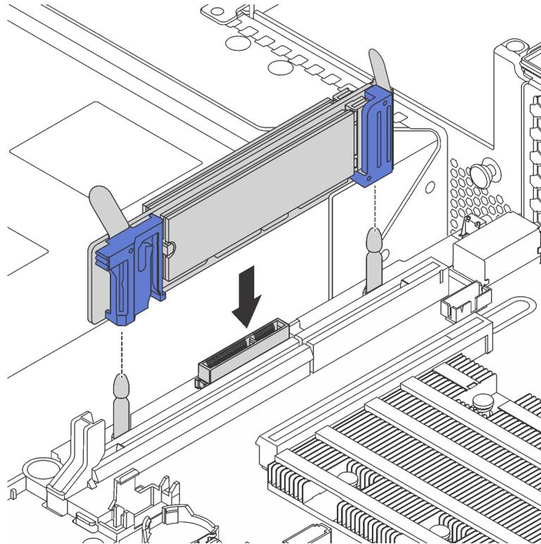
Рис. 92. Установка объединительной панели M.2
