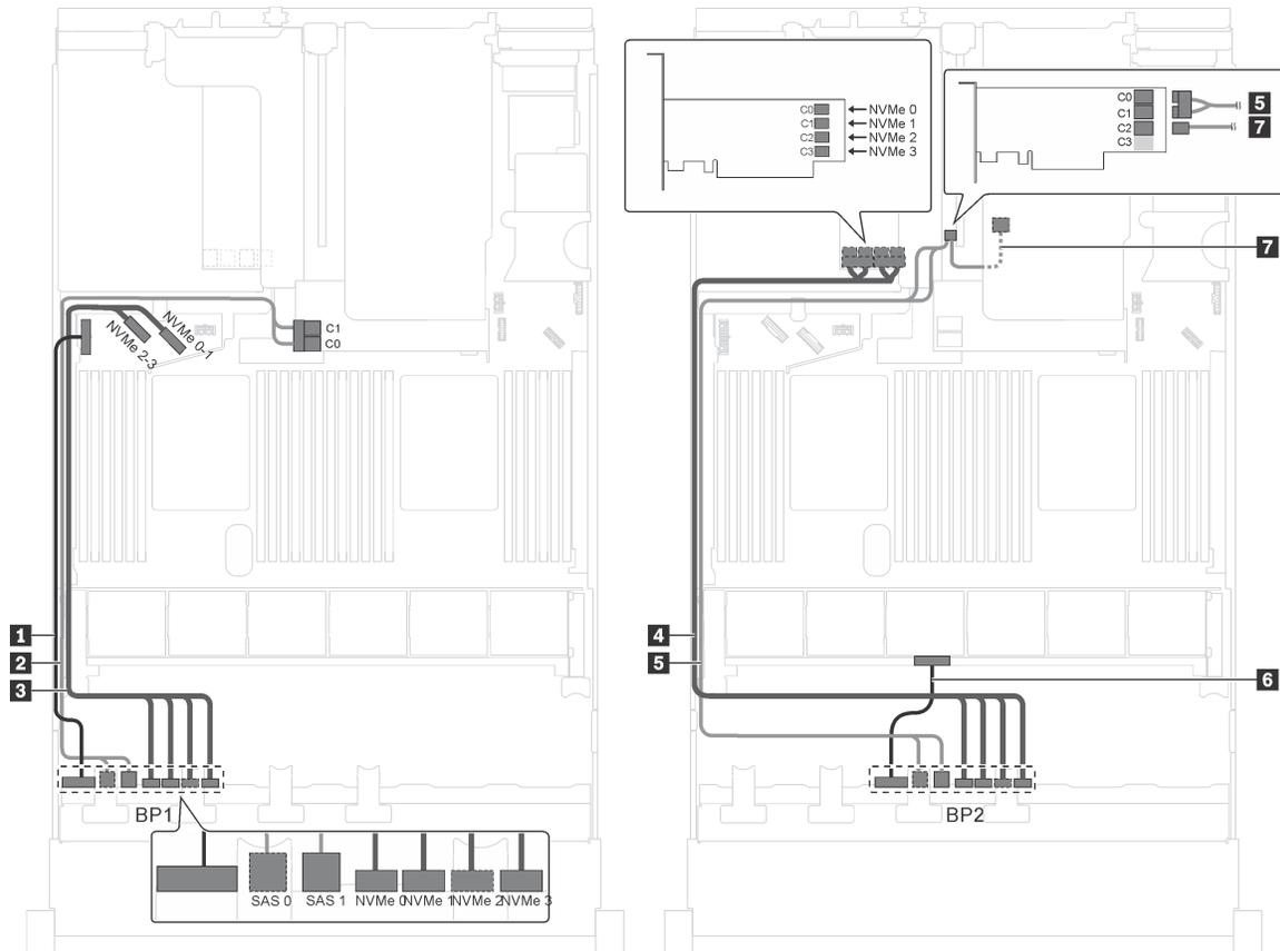
Рис. 39. Прокладка кабелей для моделей серверов с восемью 2,5-дюймовыми дисками SAS/SATA, восемью 2,5-дюймовыми дисками SAS/SATA/NVMe, задним блоком оперативно заменяемых дисков, одним адаптером RAID 8i, одним адаптером RAID 16i и одним адаптером-переключателем NVMe
