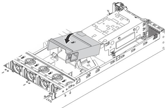
Рис. 99. Установка дефлектора графического процессора V100
