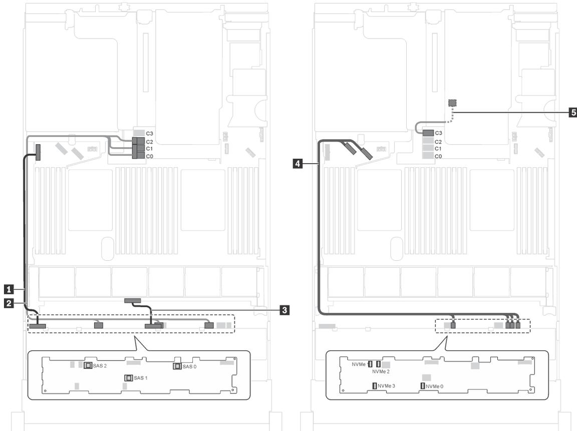
Рис. 69. Прокладка кабелей для моделей серверов с восемью 3,5-дюймовыми дисками SAS/SATA, четырьмя 3,5-дюймовыми дисками SAS/SATA/NVMe, задним блоком оперативно заменяемых дисков и одним адаптером RAID 16i
