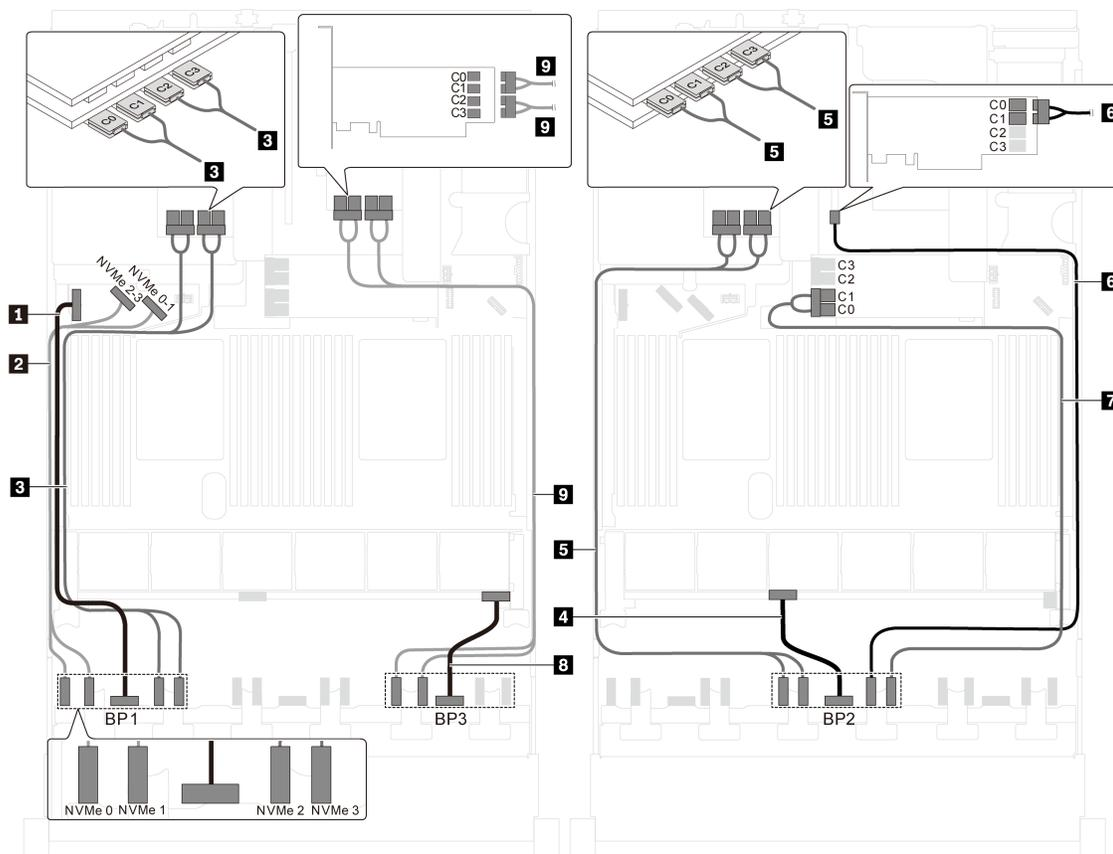
Рис. 43. Прокладка кабелей для моделей серверов с двадцатью 2,5-дюймовыми дисками NVMe, двумя адаптерами-переключателями NVMe 810-4P и тремя адаптерами-переключателями NVMe 1610-4P
