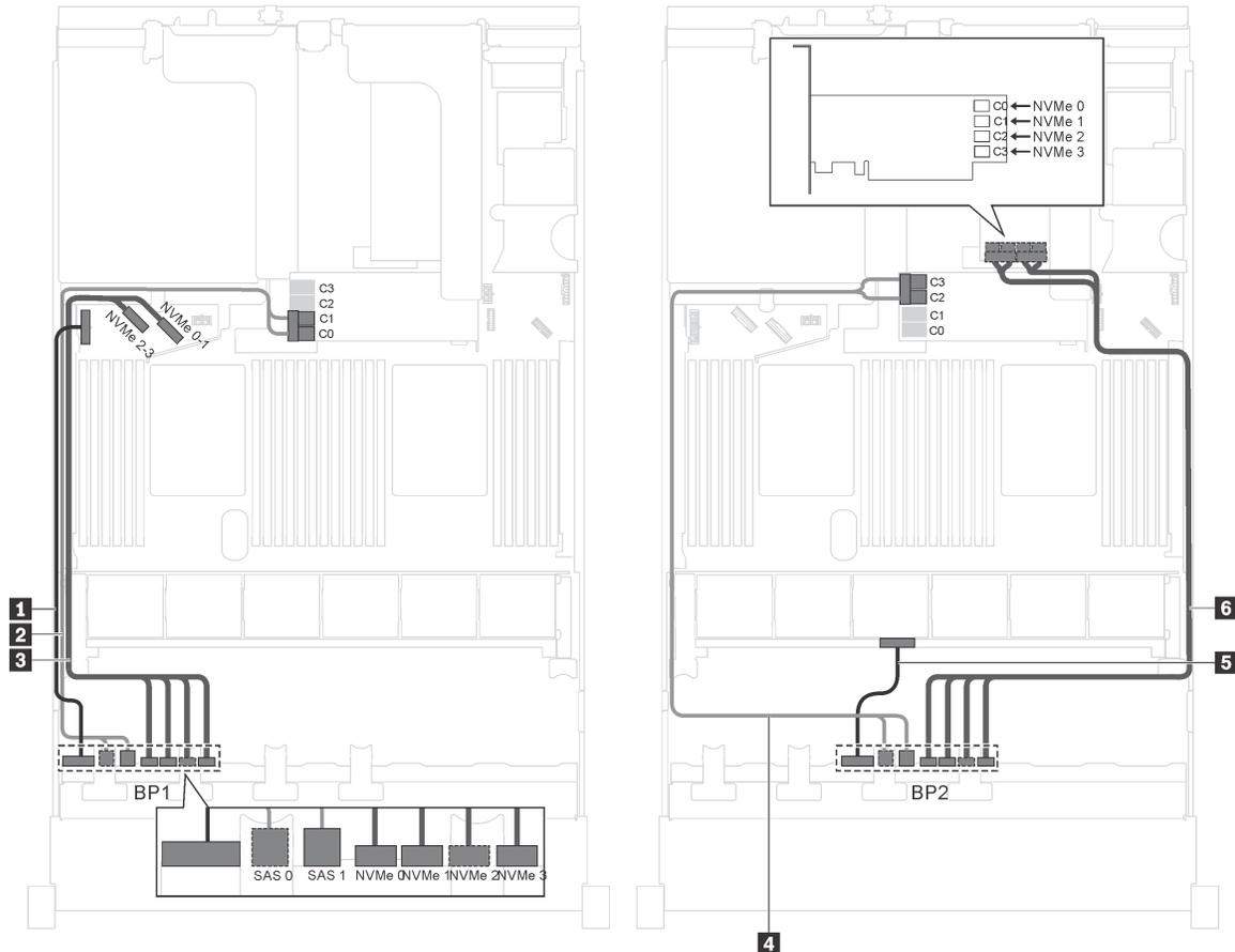
Рис. 38. Прокладка кабелей для моделей серверов с восемью 2,5-дюймовыми дисками SAS/SATA, восемью 2,5-дюймовыми дисками SAS/SATA/NVMe, одним адаптером RAID 16i и одним адаптером-переключателем NVMe
