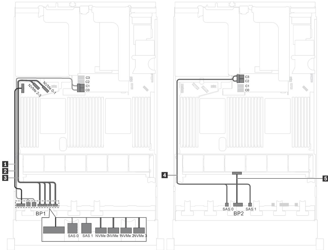
Рис. 34. Прокладка кабелей для моделей серверов с двенадцатью 2,5-дюймовыми дисками SAS/SATA, четырьмя 2,5-дюймовыми дисками SAS/SATA/NVMe и одним адаптером RAID 16i
