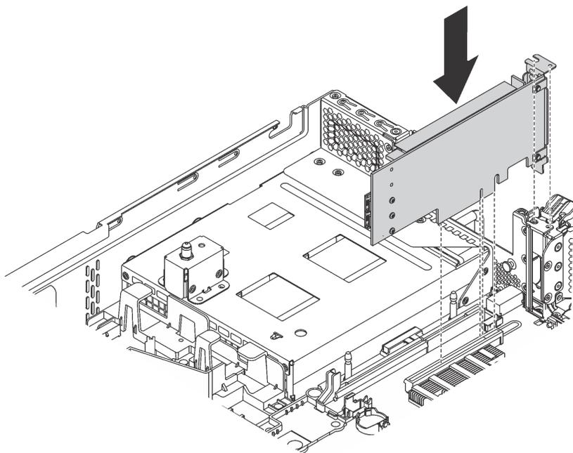
Рис. 104. Установка адаптера PCIe на материнскую плату
