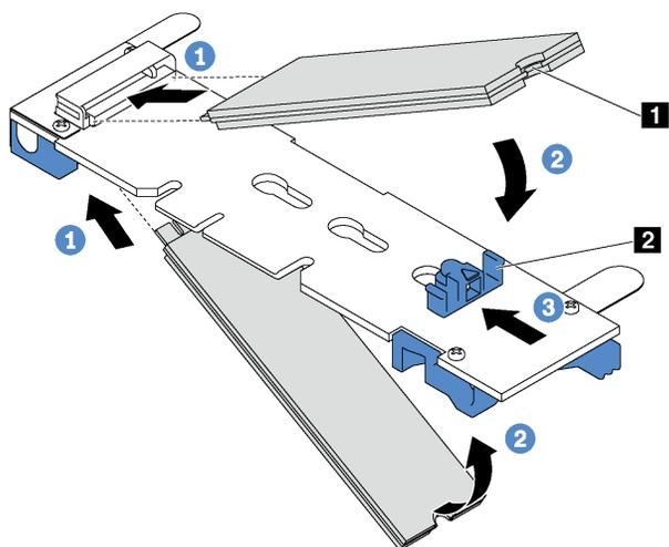
Рис. 90. Установка диска M.2
