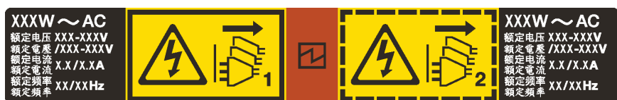
Рис. 114. Этикетка оперативно заменяемого блока питания на крышке
