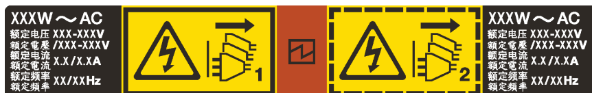
Рис. 58. Этикетка оперативно заменяемого блока питания на крышке
